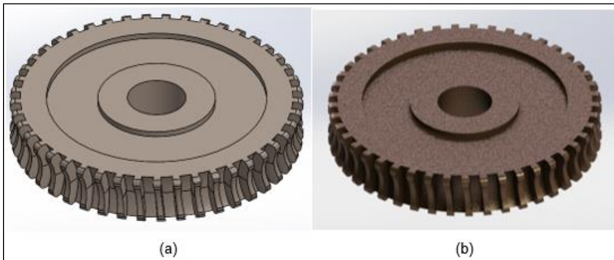
Figura 68: Corona modelada en SolidWorks. (a) Vista isométrica (b) Renderizado.
