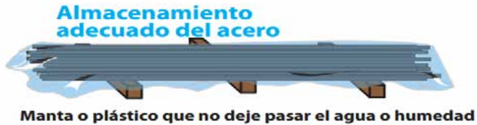
Figura 24. Almacenamiento adecuado del acero.
