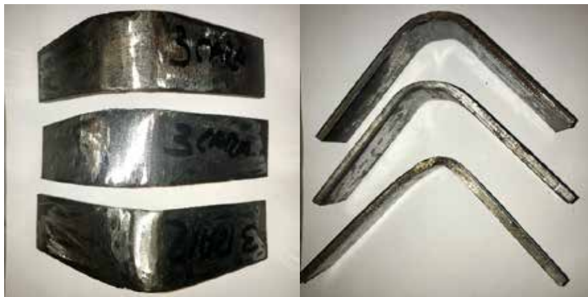
Figura 40: Doblado de las muestras número 3 (borde en V 100 A), dos de cara y una de raíz.
