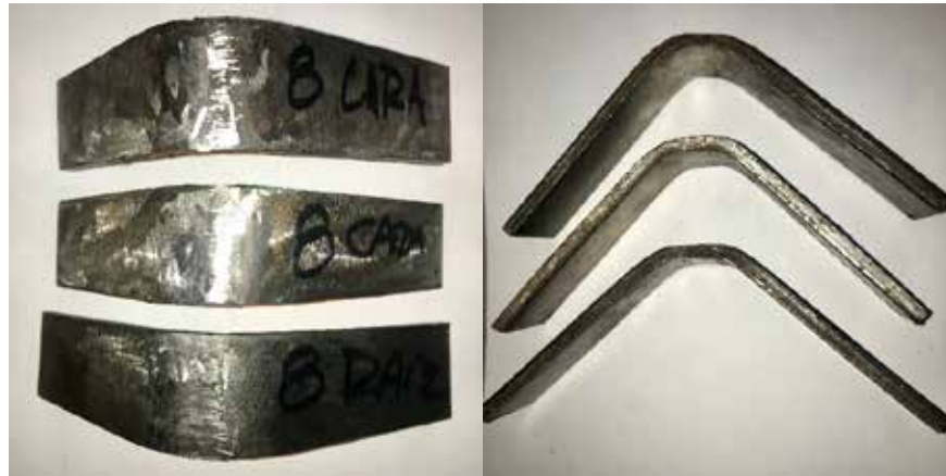
Figura 45: Doblado de las muestras número 8 (borde recto a 160 A), dos de cara y una de raíz. Fuente: Montaña-Mujica (2018)
