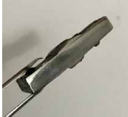
Figura 75: Macroscopía de la muestra 11, de borde en J (I = 160A).
