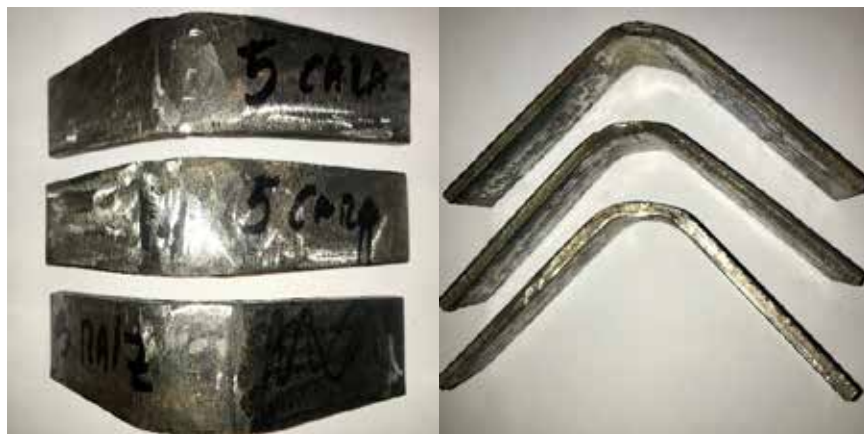
Figura 42: Doblado de las muestras número 5 (borde en U a 160A), dos de cara y una de raíz. Fuente: Montaña-Mujica (2018)
