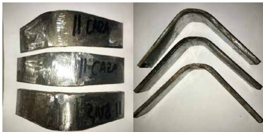
Figura 48: Doblado de las muestras número 11 (borde en J a 160 A), dos de cara y una de raíz. Fuente: Montañó-Mujica (2018)
