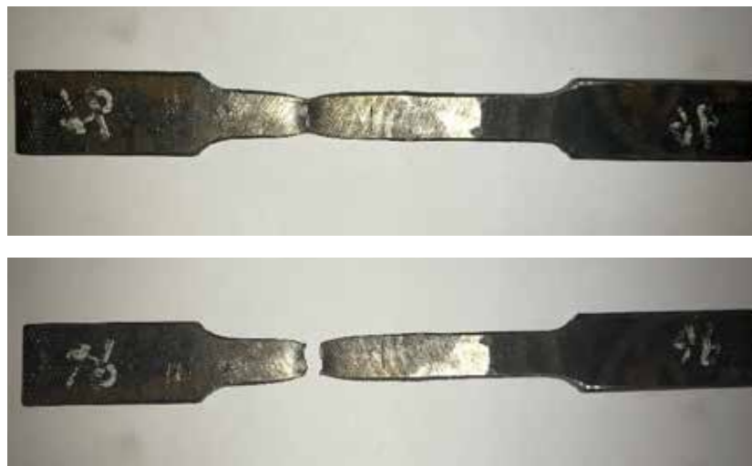
Figura 34: Probetas después de realizar el ensayo de tracción Fuente: Montaña-Mujica (2018)
