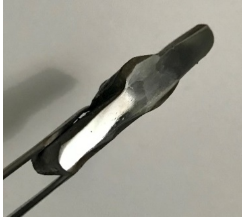
Figura 67: Macroscopía de la muestra 3, de borde V Sencilla (I = 100A). Fuente: Montaña-Mujica (2018)
