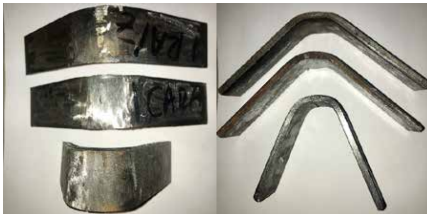
Figura 38: Doblado de las muestras número 1 (borde en V a 170 A), dos de cara y una de raíz. Fuente: Montaña-Mujica (2018)
