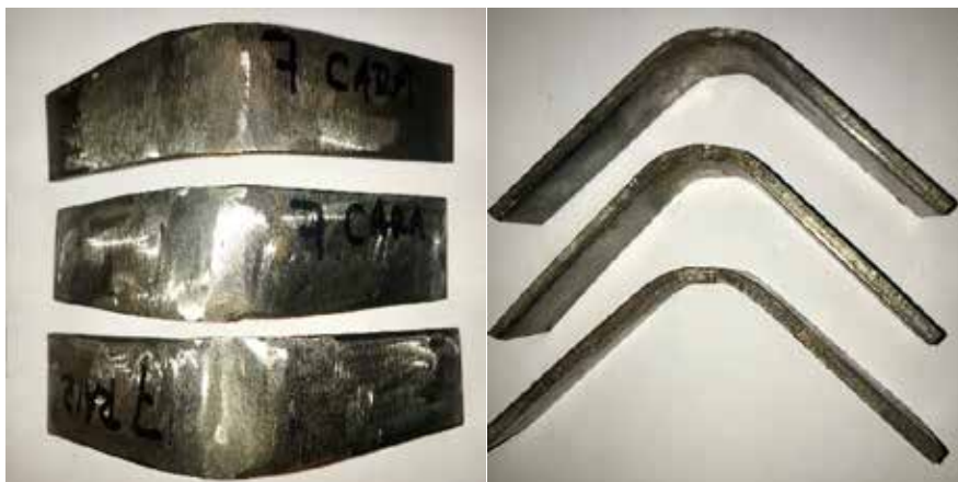
Figura 44: Doblado de las muestras número 7 (borde recto a 170 A), dos de cara y una de raíz. Fuente: Montaña-Mujica (2018)
