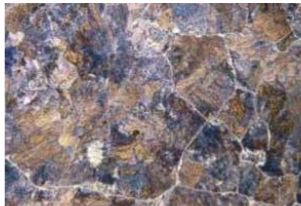
Figura 6: Presencia de Austenita. Fuente: http://throwate.blogspot.com/2014/02/los-aceros.html
