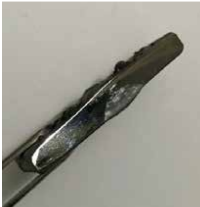
Figura 66: Macroscopía de la muestra 2, de borde V Sencilla (I = 160A). Fuente: Montañó-Mujica (2018)
