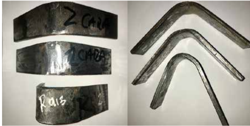
Figura 39: Doblado de las muestras número 2 (borde en V 160 A), dos de cara y una de raíz.
