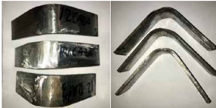
Figura 49: Doblado de las muestras número 12 (borde en J a 100 A), dos de cara y una de raíz. Fuente: Montaña-Mujica (2018)
