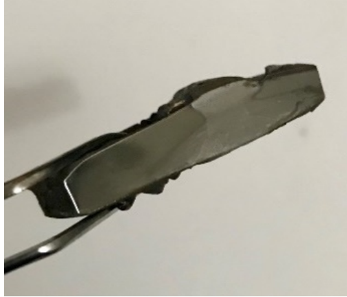
Figura 71: Macroscopía de la muestra 7, de borde RECTO (I = 170A). Fuente: Montaña-Mujica (2018)
