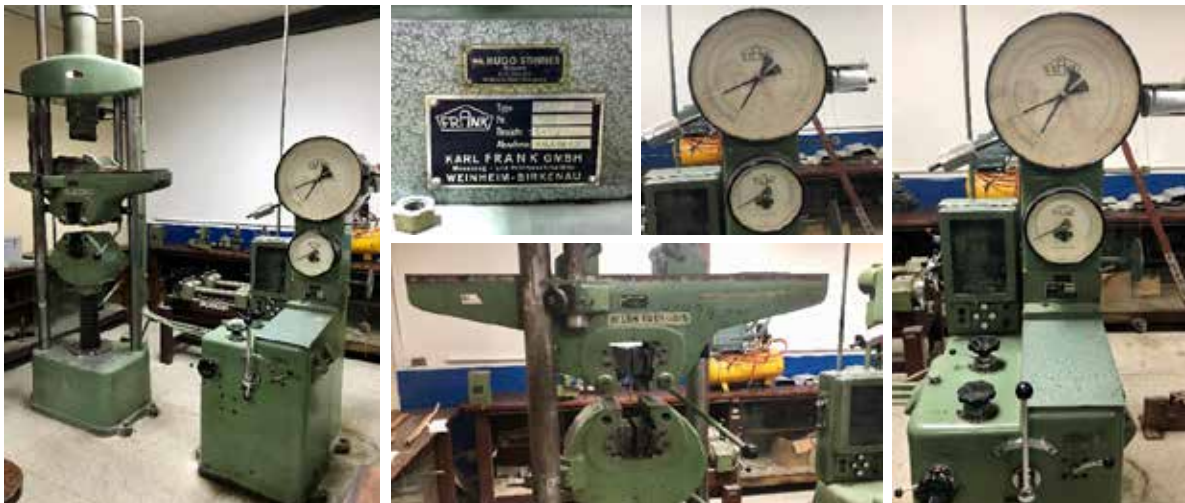
Figura 31: Máquina para ensayo de tracción FRANK. Fuente: Laboratorio de Materiales Universidad de Carabobo (2018)
