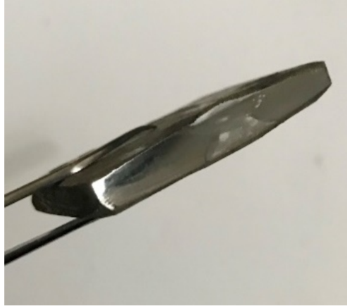
Figura 69: Macroscopía de la muestra 5, de borde U Sencilla (I = 160A). Fuente: Montaña-Mujica (2018)
