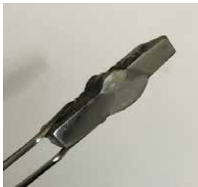
Figura 76: Macroscopía de la muestra 12, Ensayo de borde en J (I = 100A).
