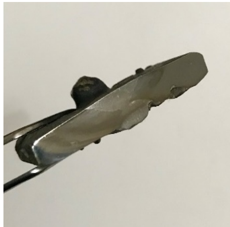
Figura 72: Macroscopía de la muestra 8, de borde RECTO (I = 160A). Fuente: Montaña-Mujica (2018)
