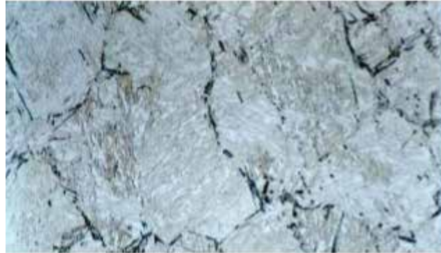
Figura 5: Presencia de vainita Fuente: López A. Tierno (2.015)
