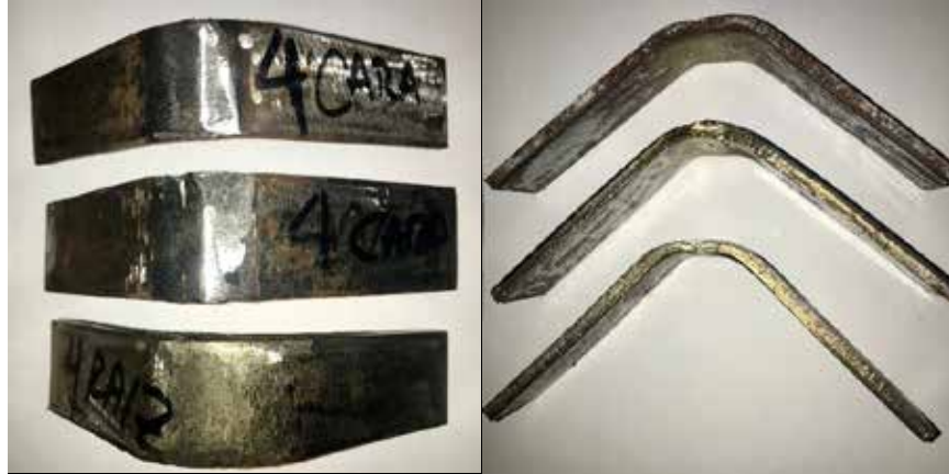
Figura 41: Doblado de las muestras número 4 (borde en U a 170 A), dos de cara y una de raíz. Fuente: Montaña-Mujica (2018)
