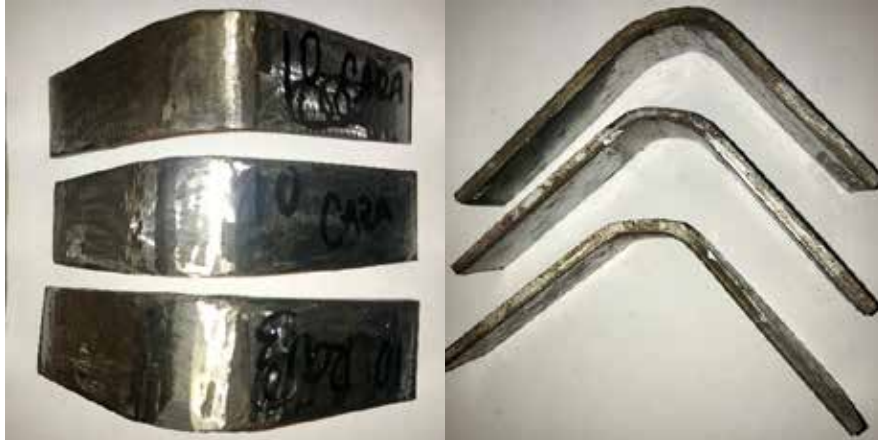
Figura 47: Doblado de las muestras número 10 (borde en J a 170 A), dos de cara y una de raíz. Fuente: Montañó-Mujica (2018)
