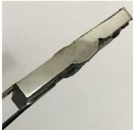
Figura 74: Macroscopía de la muestra 10, de borde en J (I = 170A). Fuente: Montañó-Mujica (2018)
