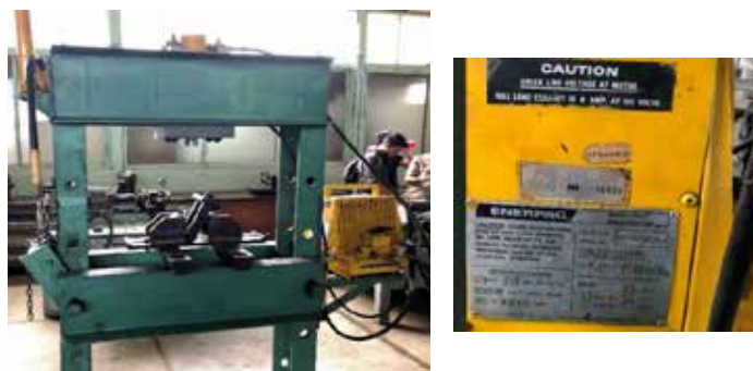
Figura 36: Máquina para ensayo de Doblado Enerpac. Fuente: Laboratorio de Materiales Universidad de Carabobo (2018)
