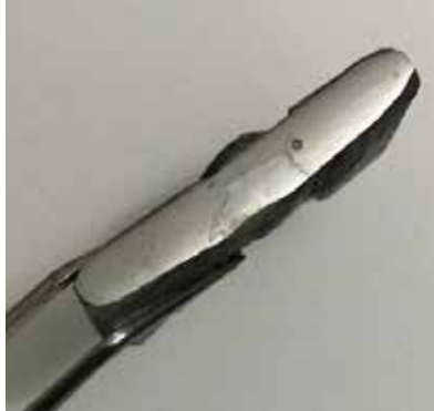
Figura 65: Macroscopía de la muestra 1, de borde V Sencilla (I = 170A). Fuente: Montañó-Mujica (2018)
