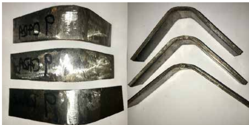
Figura 46: Doblado de las muestras número 9 (borde recto a 160 A), dos de cara y una de raíz. Fuente: Montaña-Mujica (2018)
