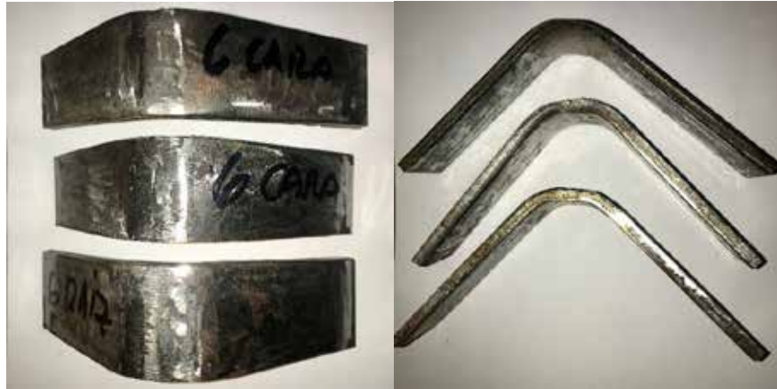
Figura 43: Doblado de las muestras número 6 (borde en U a 100 A), dos de cara y una de raíz. Fuente: Montaña-Mujica (2018)
