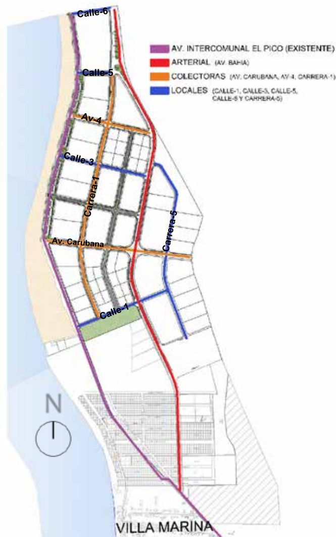
Figura 7: Sistema vial propuesto del sector El Pico, municipio Los Taques. Fuente: Presentación propuesta urbana-Diseño IX (2018).
