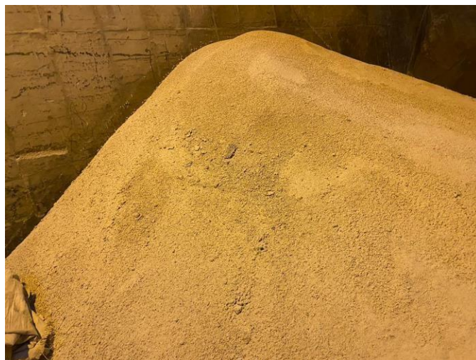
Figura 9: Producto terminado defectuoso para reproceso
