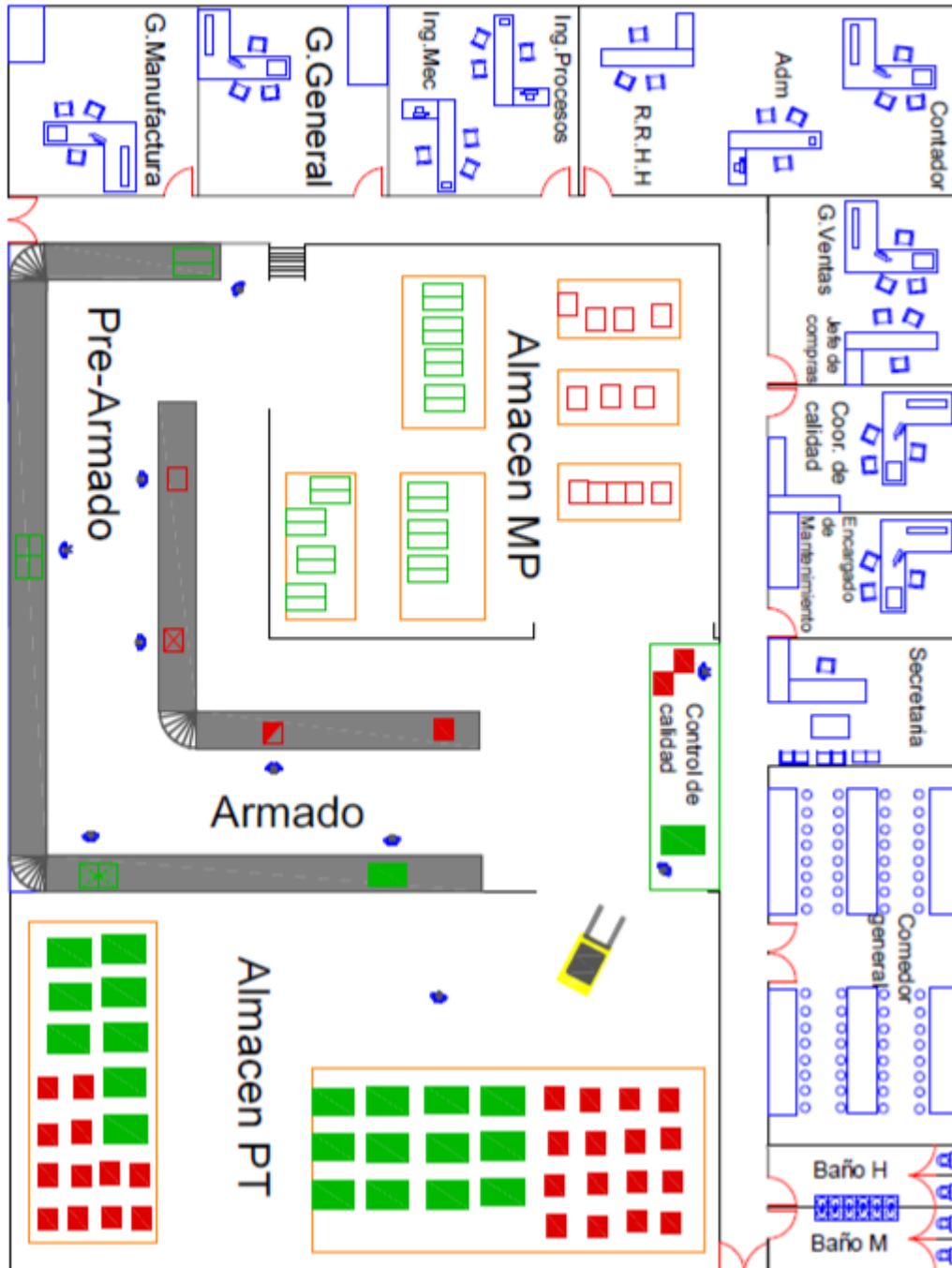
Figura 6 Vista de planta Lay-out.
