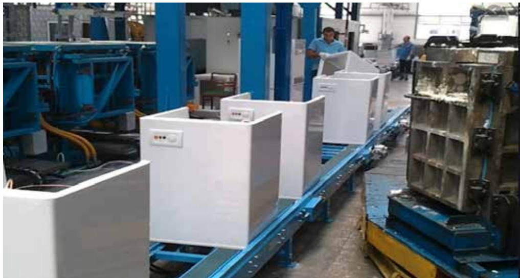
Figura 10. Imagen de referencia, línea transportadora por bandas
