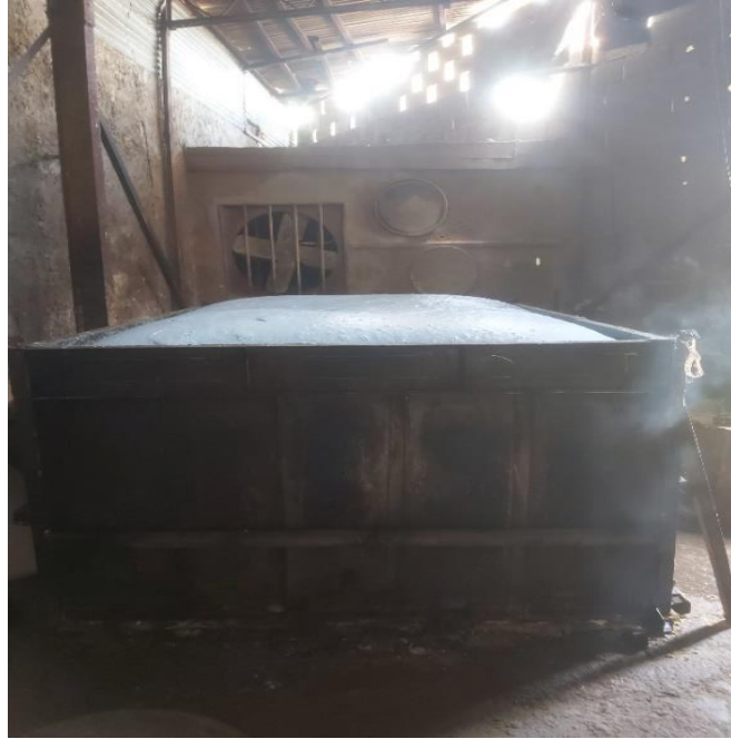
Figura 1. Emisión de gases en el proceso de fabricación de goma espuma
