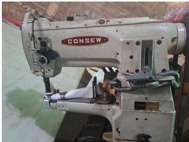
Figura 21. Máquina de Coser Marca Consew de cinta continua Autor: Barakat y Gallego (2022)
