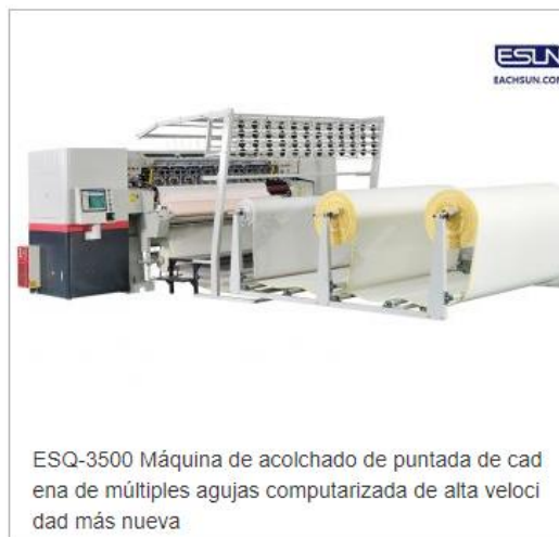
Figura 46. Máquina acolchadora continua automatizada
