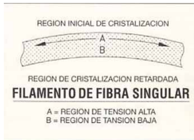
Figura 10 Cristalización Inducida Por Tensión. Fuente: Refractarios Nacionales. Grupo Morgan Advanced Materials
