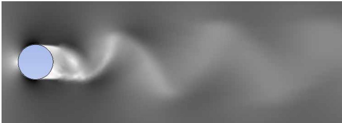
Figura 33. Visualización de la estela de Von Karman para el flujo alrededor de un cilindro. V=20 m/s
