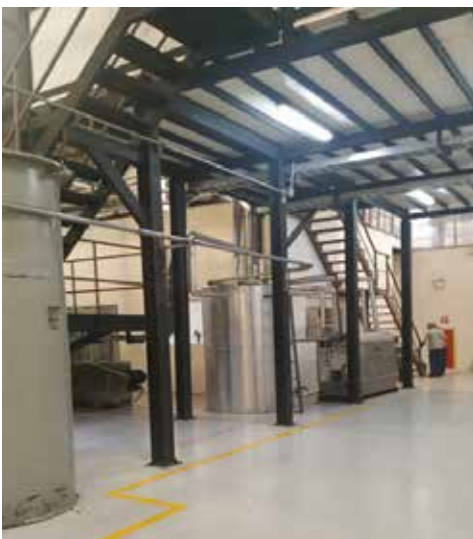
Figura 9. Almacenado - Clarificado – Temperado de la manteca de cacao Autor: Chang, P.; Peña, S. (2019) Fuente: Empresa de Cacao
