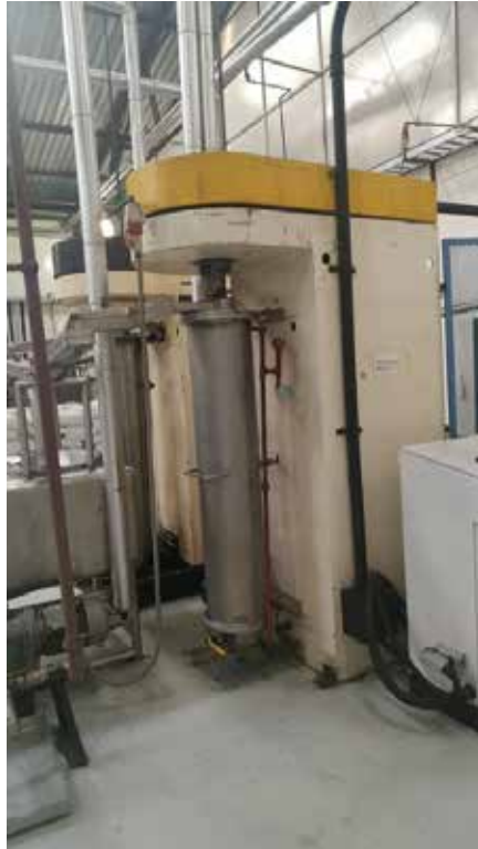
Figura 4. Pre Molino de Cuchillas Autor: Chang, P.; Peña, S. (2019) Fuente: Empresa de Cacao
