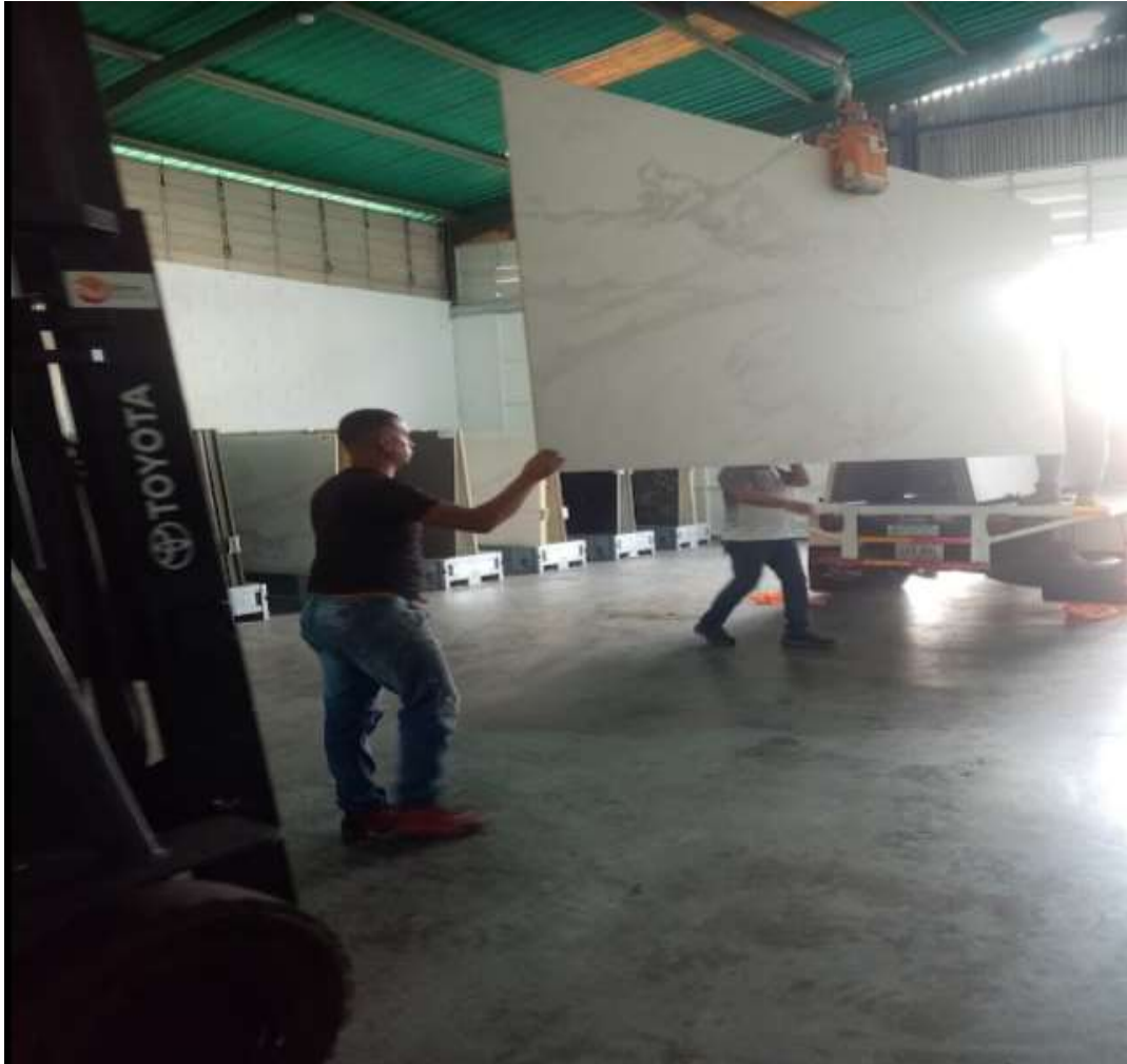
Figura N° 32. Elevación de lámina de cuarzo mediante la pinza.
