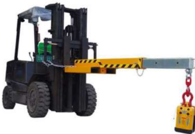
Figura Nª 30. Pinza Elevadora de Laminas ya adaptada e instalada en montacargas
