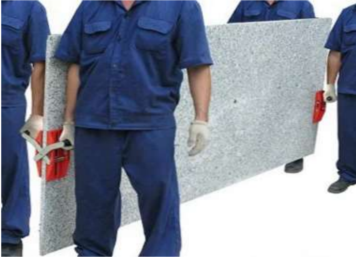
Figura N° 34. Forma en que se implementa la abrazadera de transporte manual para laminas rígidas.
