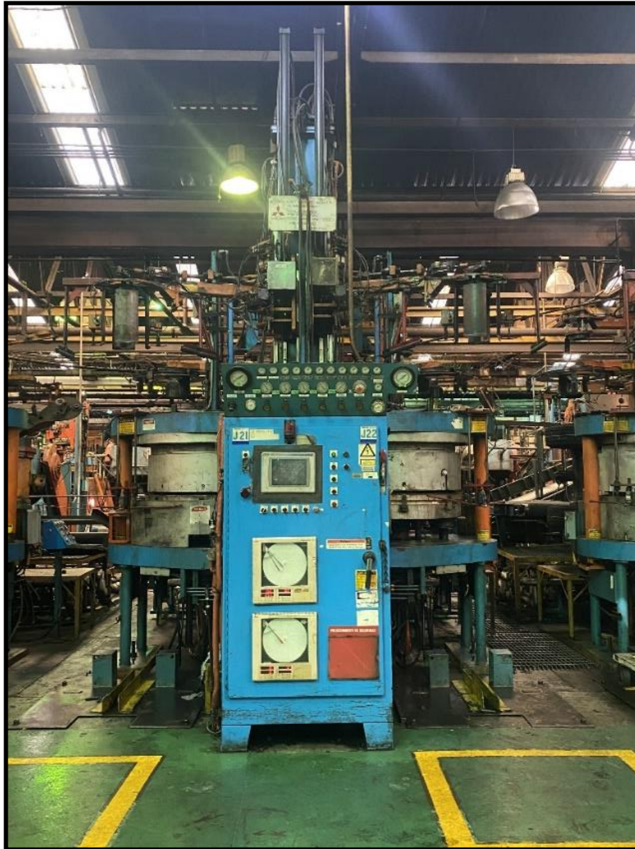
Figura 12. Máquina J21-J22 del Área de Vulcanizado, Prensa de Neumáticos de Alice Neumáticos C.A.
