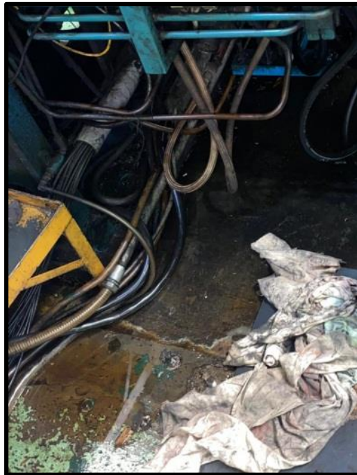
Figura 6. Muestra de Fuga y Contención de Aceite en el molde J22 de la Prensa del Área de Vulcanizado de Alice Neumáticos C.A.
