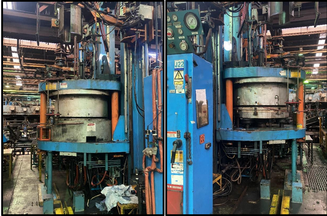
Figura 5. Molde J21-J22 de la Prensa Vulcanizadora de Neumáticos de Alice Neumáticos C.A.
