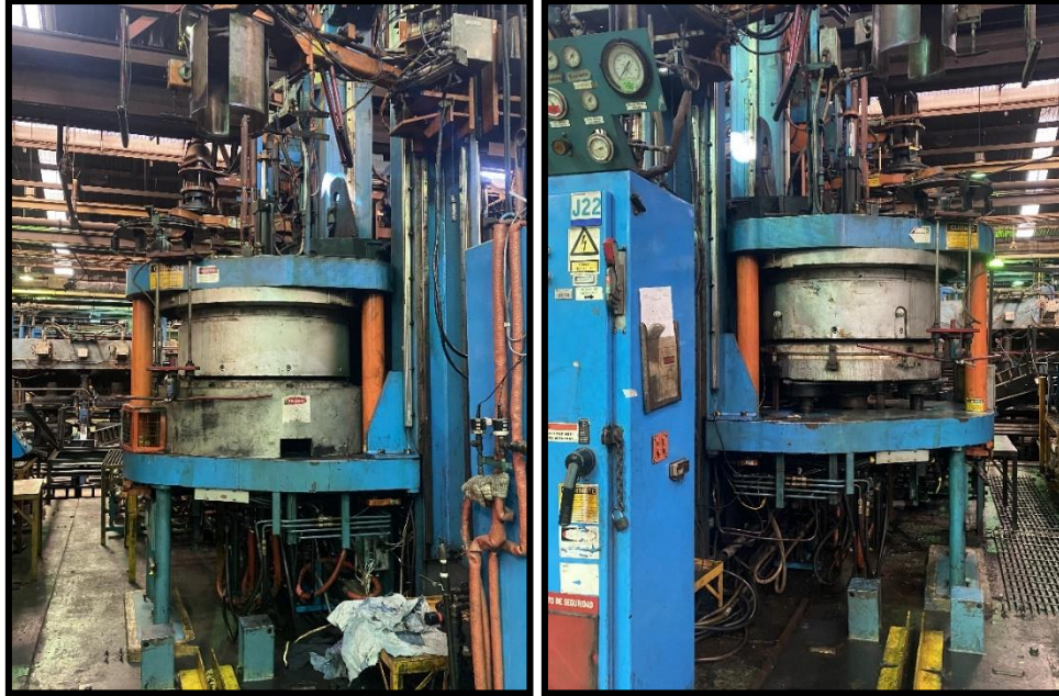
Figura 13. Molde J21-J22 de la Prensa Vulcanizadora de Neumáticos de Alice Neumáticos C.A.
