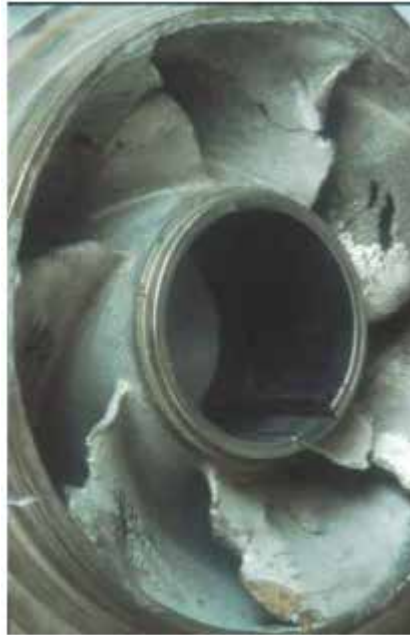
Figura 3. Bomba afectada por el fenómeno de la cavitación.
