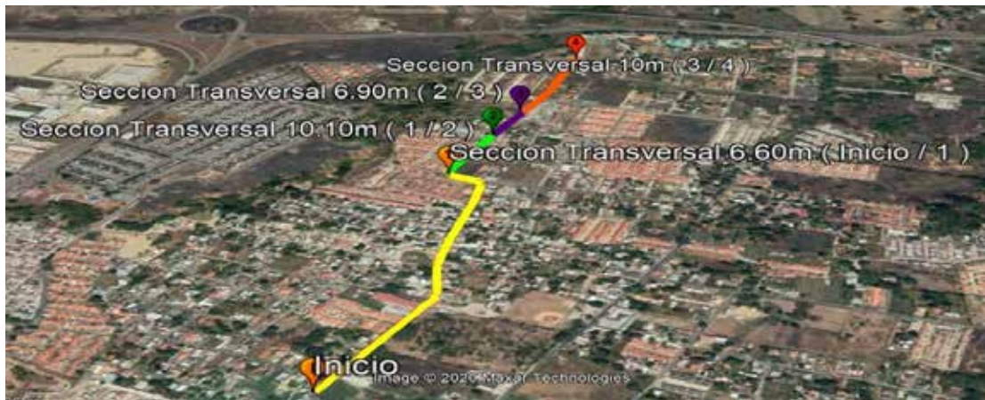
Figura N° 52: Tramos por sección Transversal.
