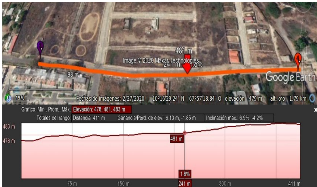
Figura N°64: Perfil Longitudinal del tramo (3 – 4)
