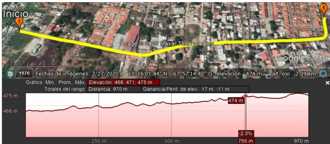
Figura N°61: Perfil Longitudinal del tramo (Inicio – 1)
