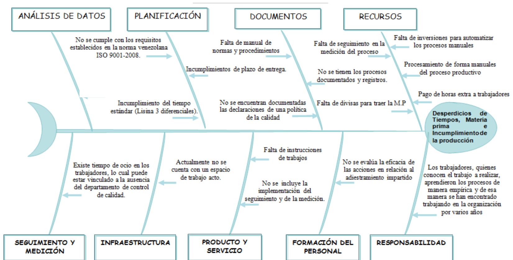
Figura 11 Diagrama de causa-efecto del proceso de fabricación de químicos de la empresa DougSoluciones C.A. Fuente: Basanta, J. (2020).
