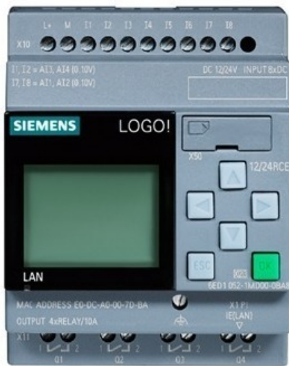
Figura 8: PLC nano tipo logo. Fuente: Utrera. J (2020).
