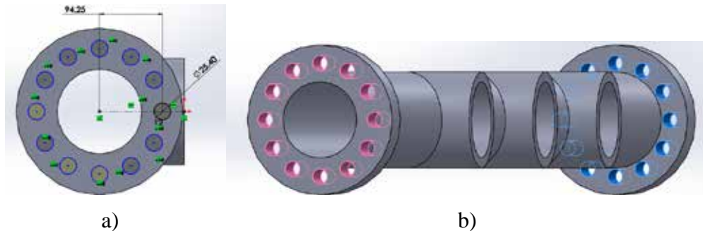
Figura 27. Croquis 4, Corte 2 y Mirror 2, Manifold de Alta. Fuente: El Atrache y Vázquez. (2020).
