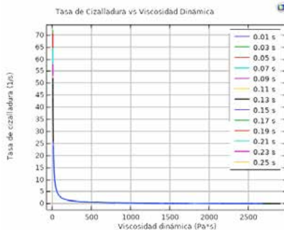
Gráfica 8. Tasa de Cizalladura (Deformación) vs Viscosidad Dinámica, Carga. Fuente: El Atrache y Vázquez. (2020).
