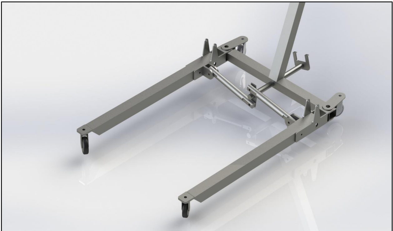
Figura 35. Sistema de apertura manual. Fuente: Herrera, L (2023).
