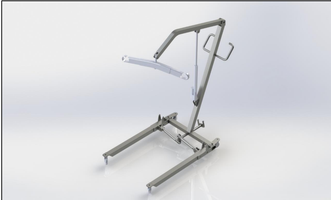
Figura 28. Solución seleccionada: Sistema de elevación para el traslado de personas con movilidad reducida por obesidad mórbida (PS 1 ). Fuente: Herrera, L (2023).
