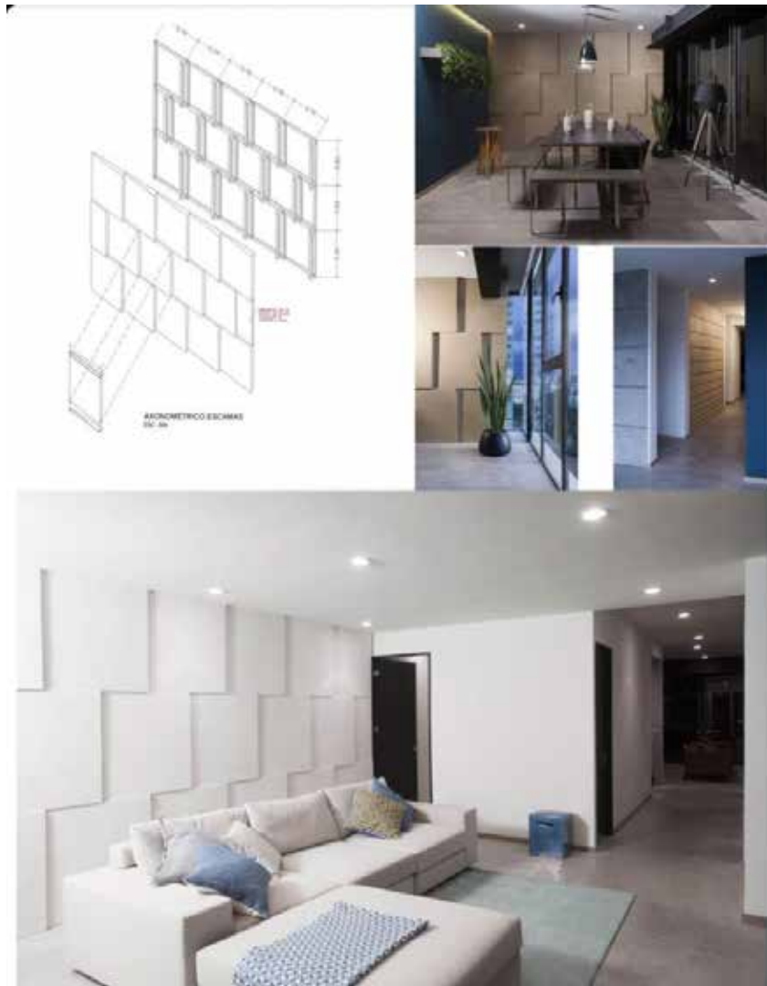
Figura 32. Detalle de lamas de losetas prefabricadas de hormigón y madera. (2017)
