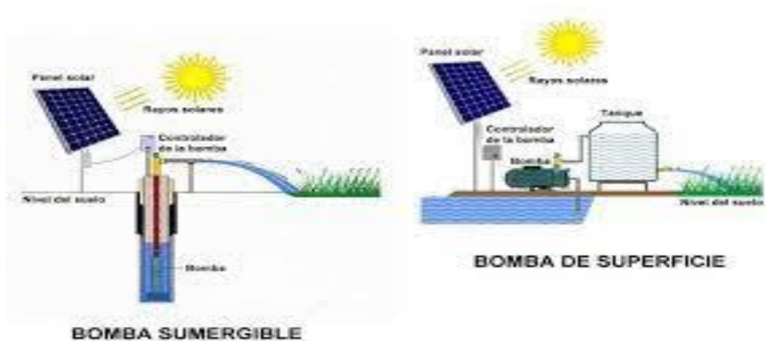
Figura 7. Tipos de Sistemas Fotovoltaicos de Bombeo
