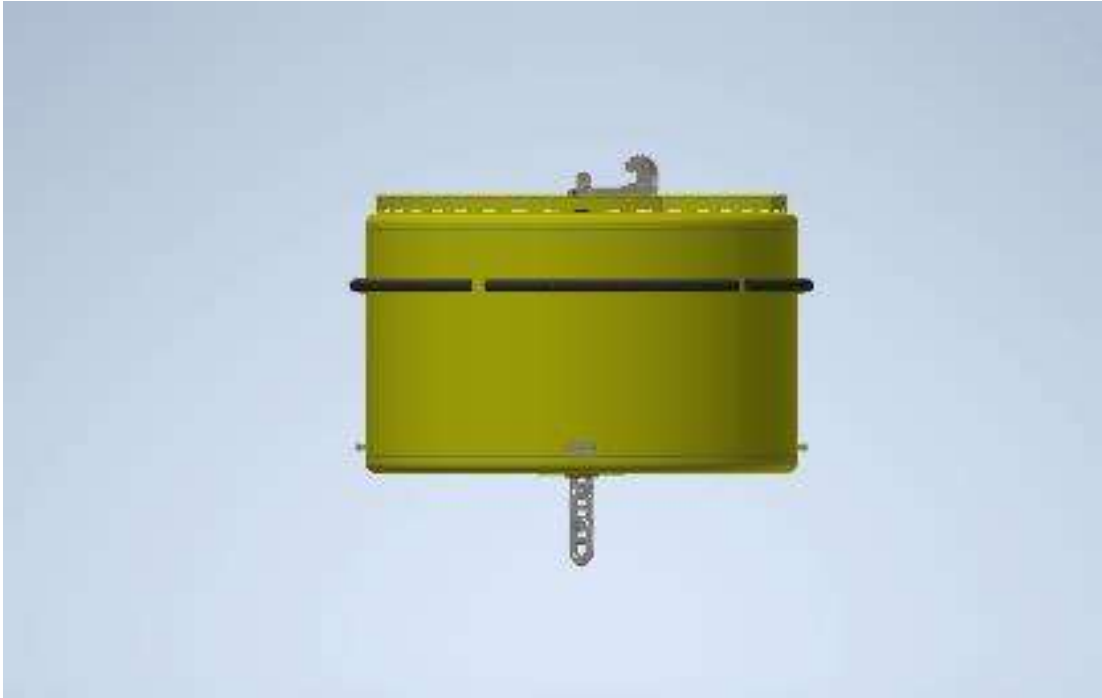
Figura 41. Vista alzado de diseño de boya de amarre. Fuente: Autores.
