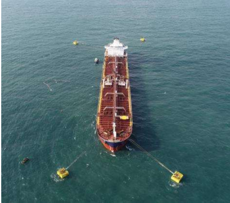
Figura 16. Sistema de amarre tipo multiboya. Fuente: Orwell Offshore.
