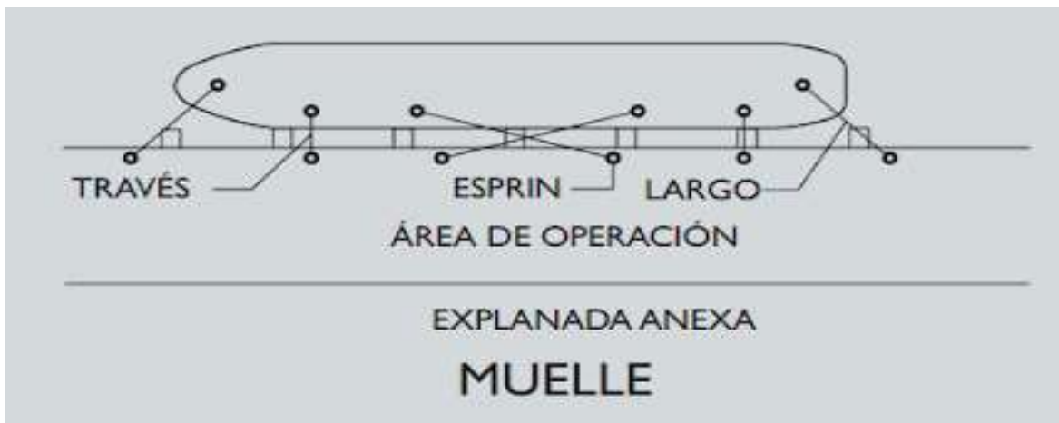
Figura 7. Ejemplo de muelle con explanada anexa.
