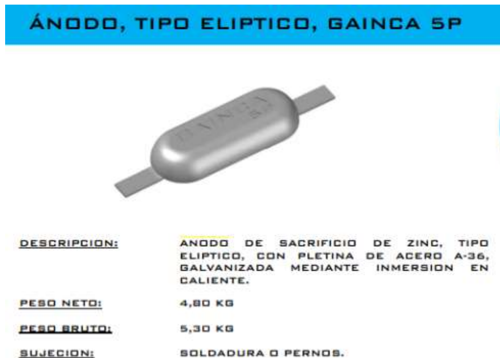
Figura 38. Características de ánodo de Zinc tipo elíptico. Fuente: GAINCA C.A.
