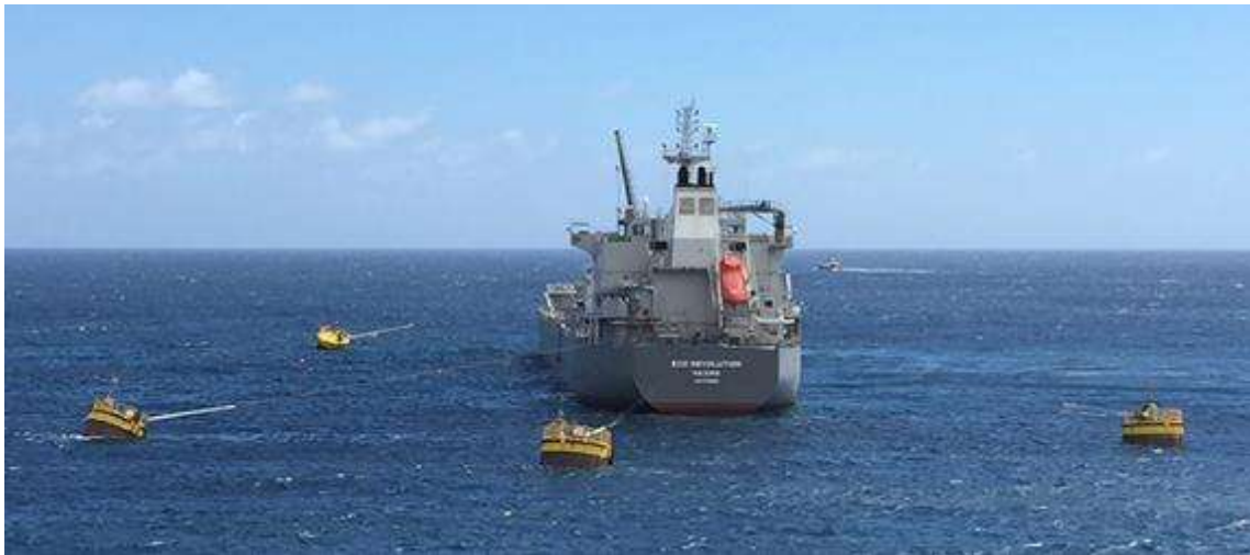
Figura 17. Sistema de amarre tipo multiboya. Fuente: Orwell Offshore.
