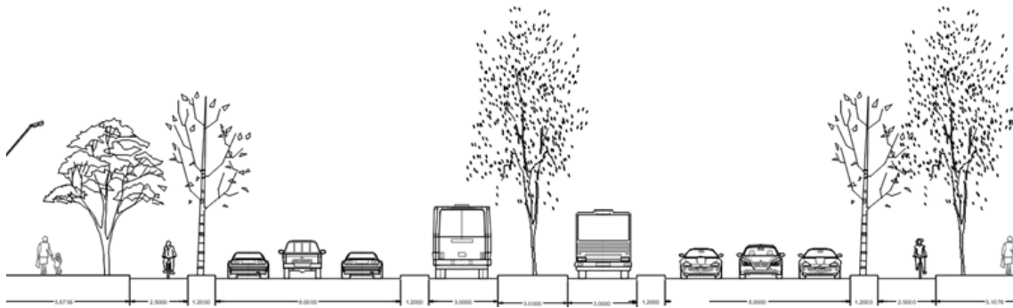
Figura 13. Corte Transversal de la Propuesta de Transporte (BRT) en el Sector Valles de Camoruco.
