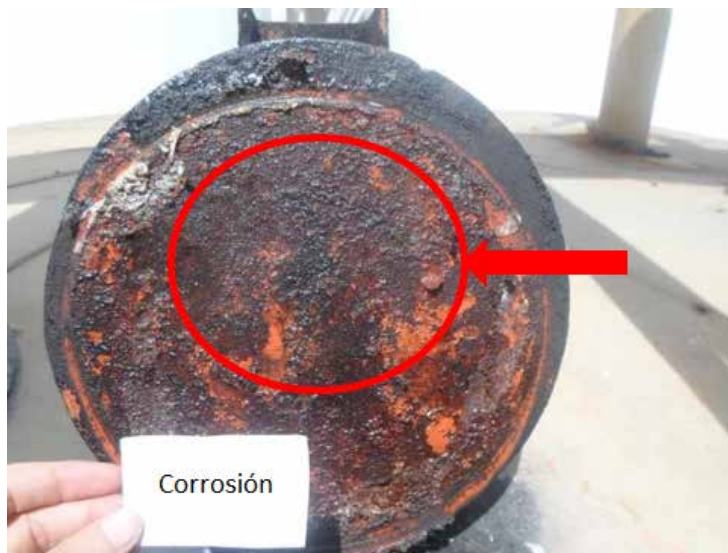
Figura 24: Corrosión brida interna
