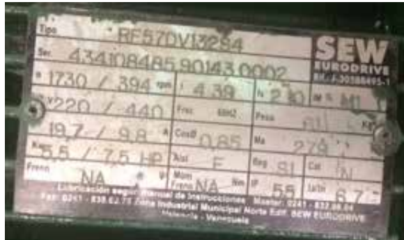
Figura 35: Data técnica motor/reductor
