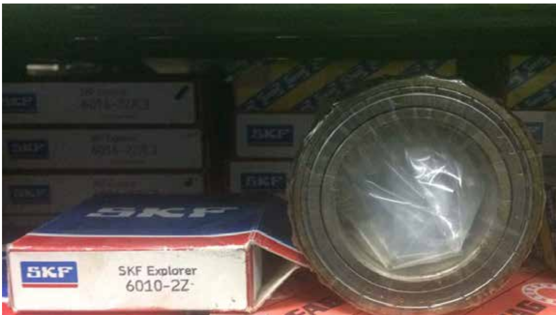
Figura 33: Rodamientos SKF 6010-2Z
