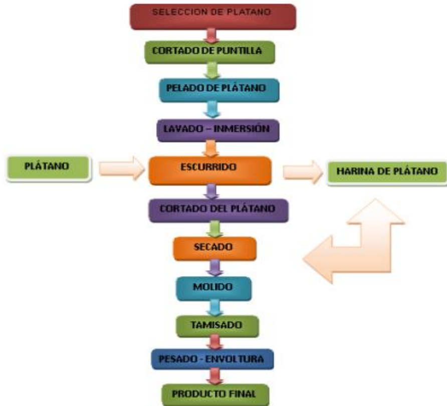
Figura 13 Diagrama de bloque del proceso de fabricación de la harina de plátano.
