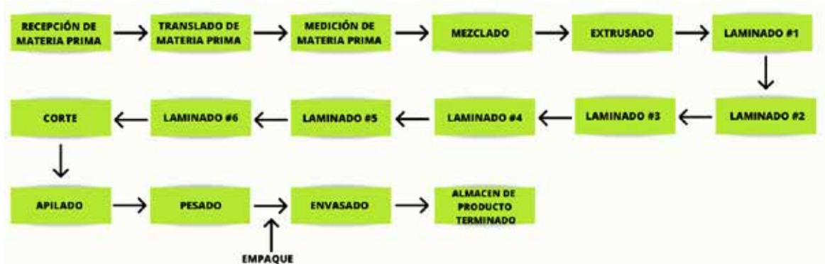
Figura 13. Proceso de fabricación de masa lista para pastelitos Fuente: Tequeñería El Tequeñon C.A Autor: Di Modugno (2021)
