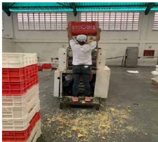
Figura 21. Levantamiento manual de mezcla en la maquina extrusora
