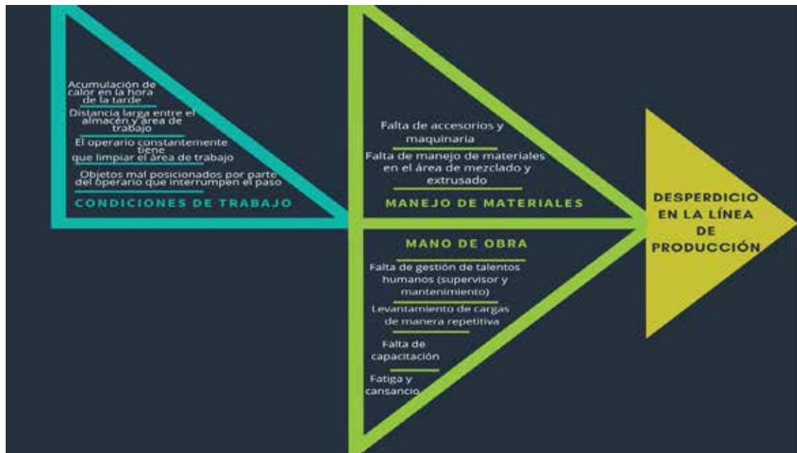
Figura 19. Diagrama Ishikawa 2. Desperdicio en la línea de producción Autor: Di Modugno, G (2021)
