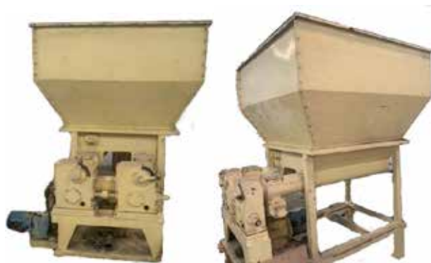
Figura 26. Tolvas para el área de Mezclado
