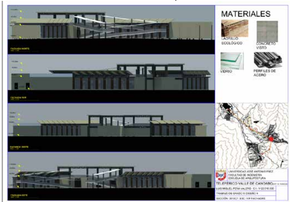
Figura 18: Fachadas de la Estación El Parque Fuente: Propia
