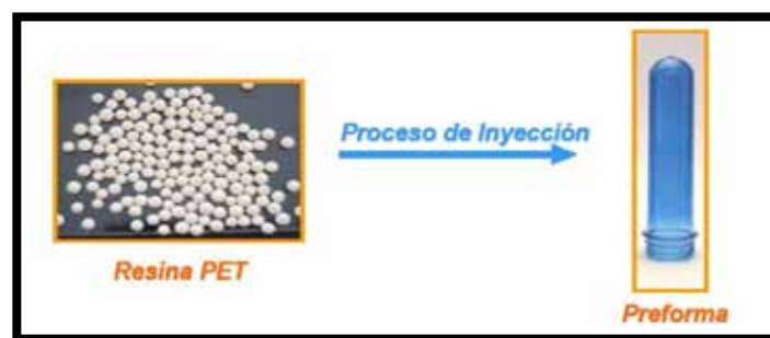
Figura 4 Proceso de Inyección de Preformas PET.
