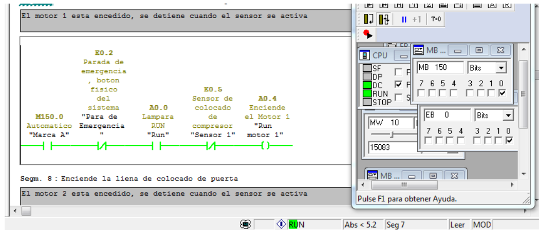
Figura 41. Enciende el Motor 1 de la banda transportadora Fuente: Torrens (2021)
