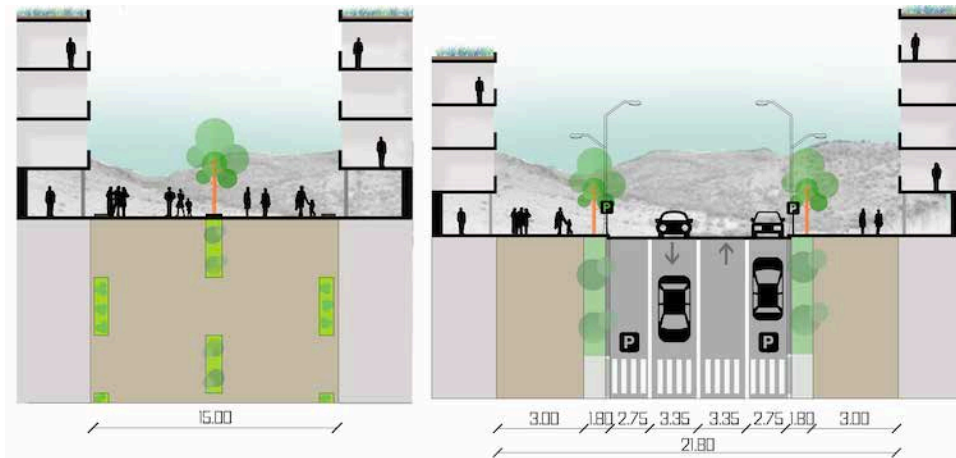
Figura 21: Perfil vial peatonal y vehicular (2017)
