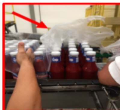
Imagen #6. Plástico fuera de las especificaciones de producción.
