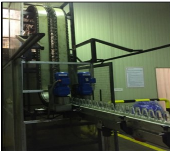
Figura 8: Botellas descendiendo por el cuello de jirafa hacia llenadora.
