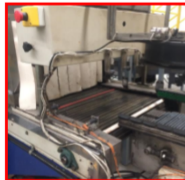
Imagen #8. Banda transportadora al final de la Termoencogible.
