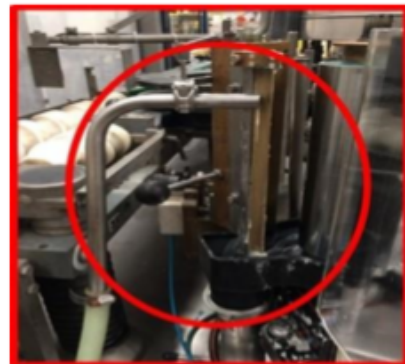
Imagen #4. Áreas donde suelen quedar residuos de pega.
