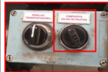
#Imagen #16. Selector para cerrar compuerta.
