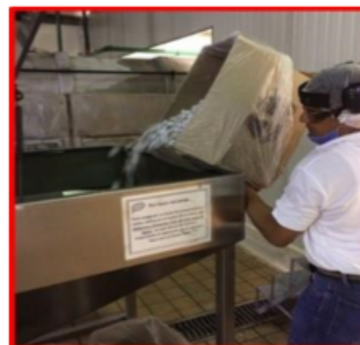
Imagen #7. Operador insertando tapas en tolva.
