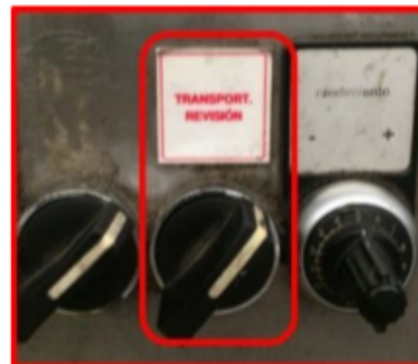
Imagen #9. Selector "Transport. Revisión".
