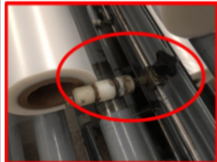
Imagen #12. Rosca para ajuste del rollo.
