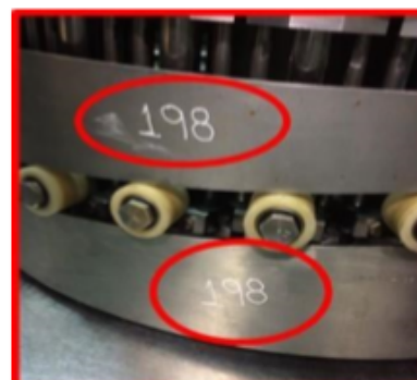
Imagen #5. Levas superior e inferior identificadas.
