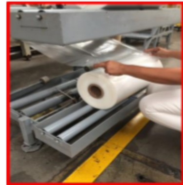
Imagen #10. Empate del film inferior con cinta pegante.
