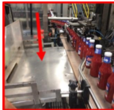
Imagen #3. Bandeja lateral de envases rechazados.
