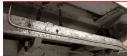
Imagen #4. Gancho metálico que se utiliza para levantar botellas.
