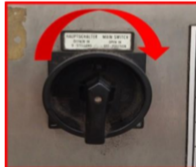
Imagen #6. Selector principal para arrancar máquina.
