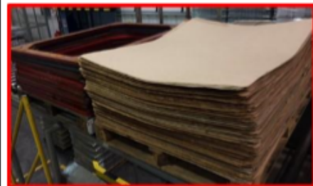
Imagen #3. Marco y Cartón colocados en la parte superior del despaletizador.
