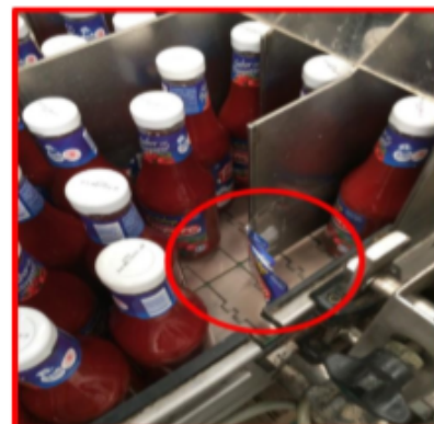
Imagen #6. Etiqueta pegada en separador de envases.
