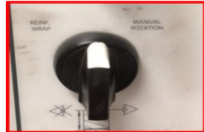
Imagen #7. Selector de rotación manual.
