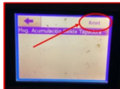
Imagen #8. Opción "reset" en pantalla de control de la tapadora.
