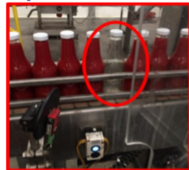
Imagen #4. Camada de botellas con un envase vacío paradas por el sensor.
