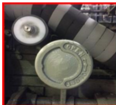
Imagen #4. Volante para ajuste del gusano.
