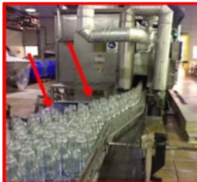
Imagen #4. Botellas entrando a la esterilizadora.
