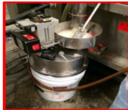
Imagen #5. Cuñete de pegamento ubicado en la bomba succionadora de pega.
