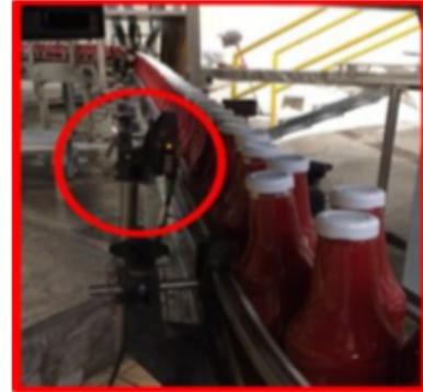
Imagen#2. Sensor detector de botellas.
