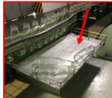
Imagen #6. Botellas caídas en bandeja lateral.
