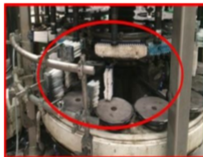
Imagen #9. Cepillos para adhesión de etiquetas.
