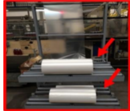
Imagen #11. Rollos de film superior e inferior.
