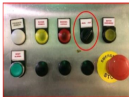
Imagen #9. Selector girado en dirección "AUT".
