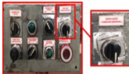
Imagen #11. Selector de brazo hidráulico para mover botellas.
