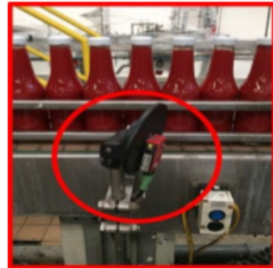
Imagen #3. Sensor detector de envases llenos.
