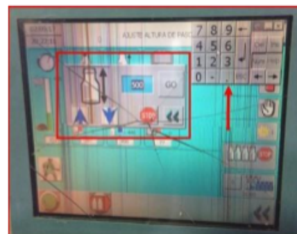
Imagen #4. Ajuste de altura del pico de la llenadora.
