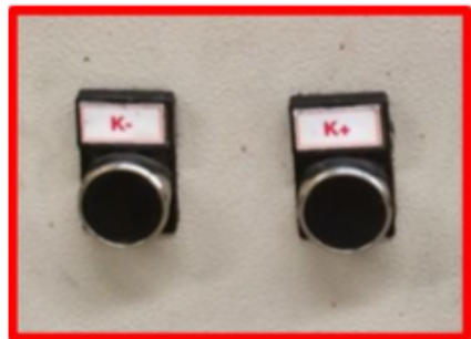
Imagen #7. Botones para bajar o subir la posición del brazo mecánico. .
