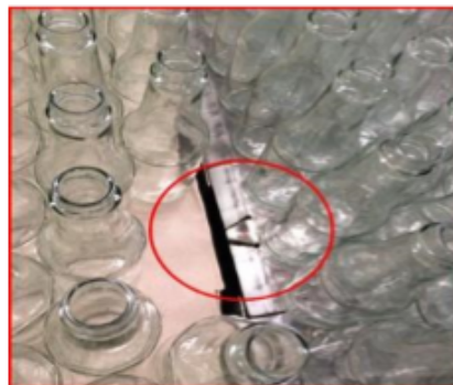
Imagen #1. "Uña" que debe estar por encima de la lámina de cartón.
