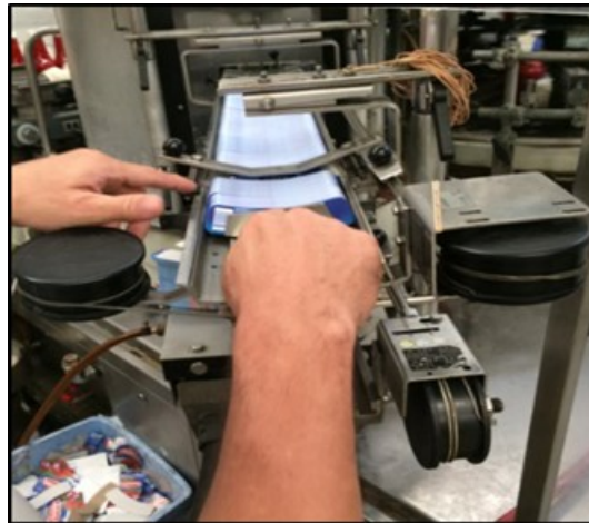
Figura 11: Operador coloca etiquetas en magazín para etiquetas.
