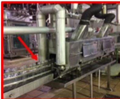
Imagen #3. Botellas entrando a la esterilizadora.
