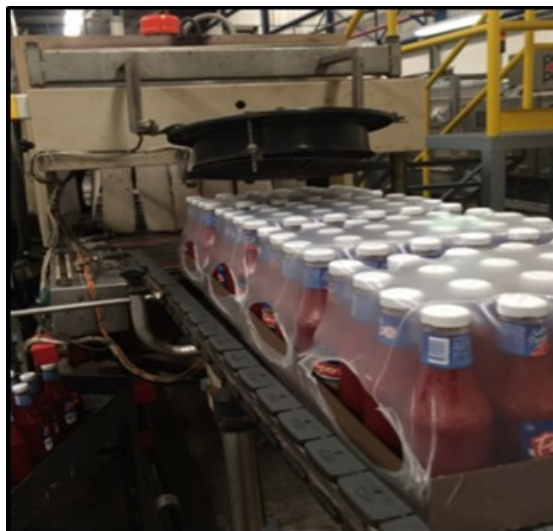
Figura 13: Cajas de salsas armadas en la salida de la termoencogible.
