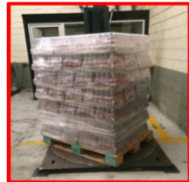
Imagen #3. Paleta en disco giratorio de Envolvedora.
