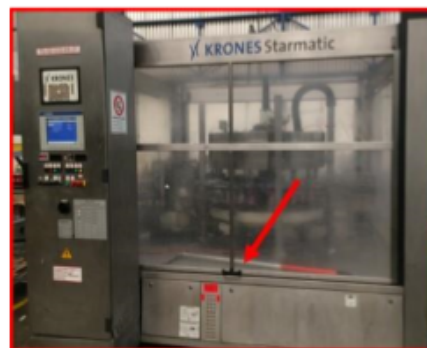
Imagen #1. Manilla para abrir puerta protectora.
