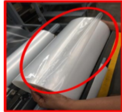
Imagen #9. Empate del Film con cinta pegante.
