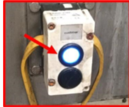
Imagen #5. Botón "confirmar" para reanudar el traslado de envases.
