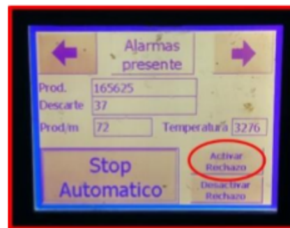
Imagen #9. Opción "activar rechazo" en pantalla de control de la tapadora.
