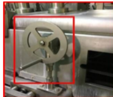
Imagen #3. Volante que ajusta guía lateral de la tapadora.
