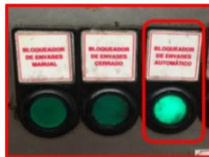
Imagen #12. Botón Bloqueador de Envases Automático.
