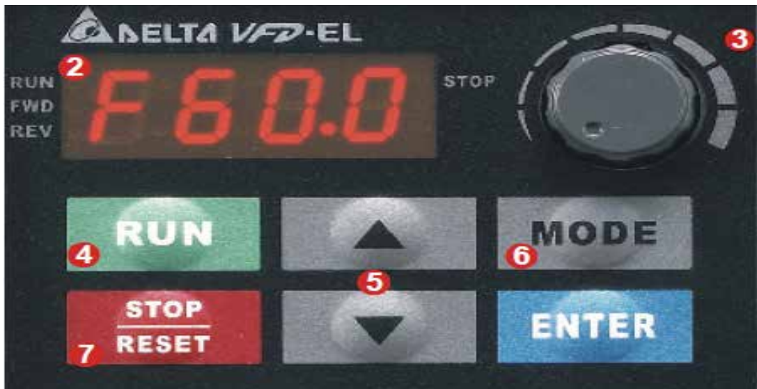
Figura 7. Identificación del teclado digital del variador de frecuencia. Fuente: Tomado de la empresa Delta, C.A. (2017).
