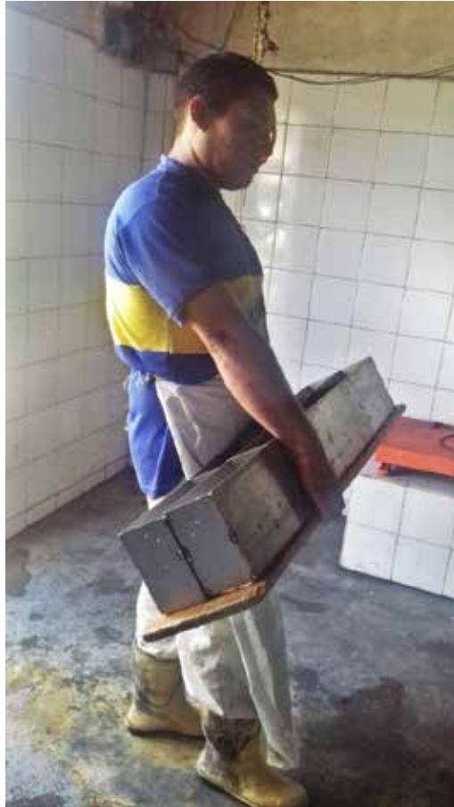
Figura 11: Traslado de moldes a la cava refrigerada
