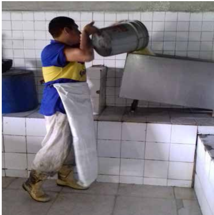
Figura 9: Desuerado - Vaciado del suero en el tanque recolector
