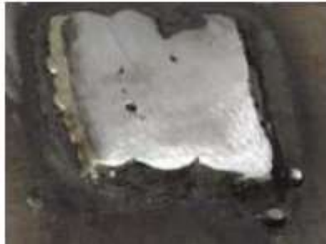
Figura 41: Cupón para análisis químico del depósito de soldadura.
