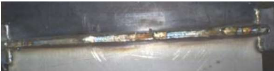
Figura 49: Junta soldada definitiva para la evaluación, SMAW.
