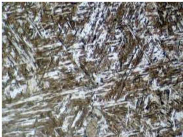
Figura 4: Presencia de Martensita
