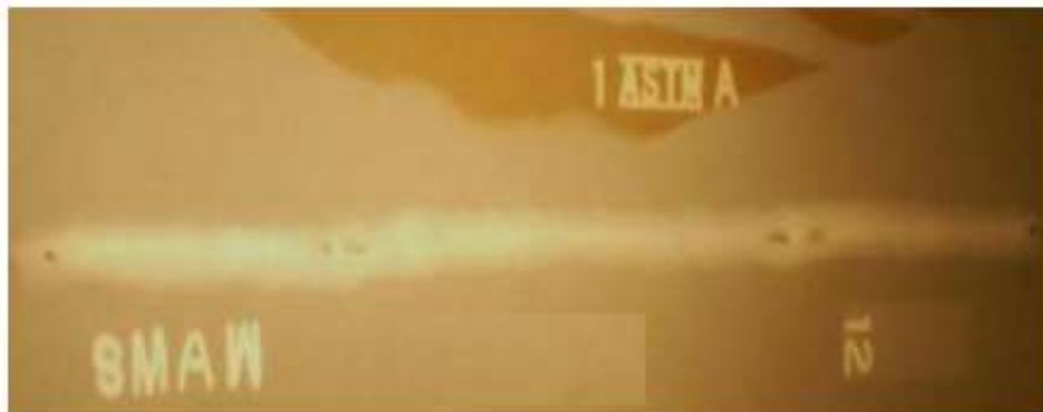
Figura 54: Radiografía industrial para la junta disímil SMAW
