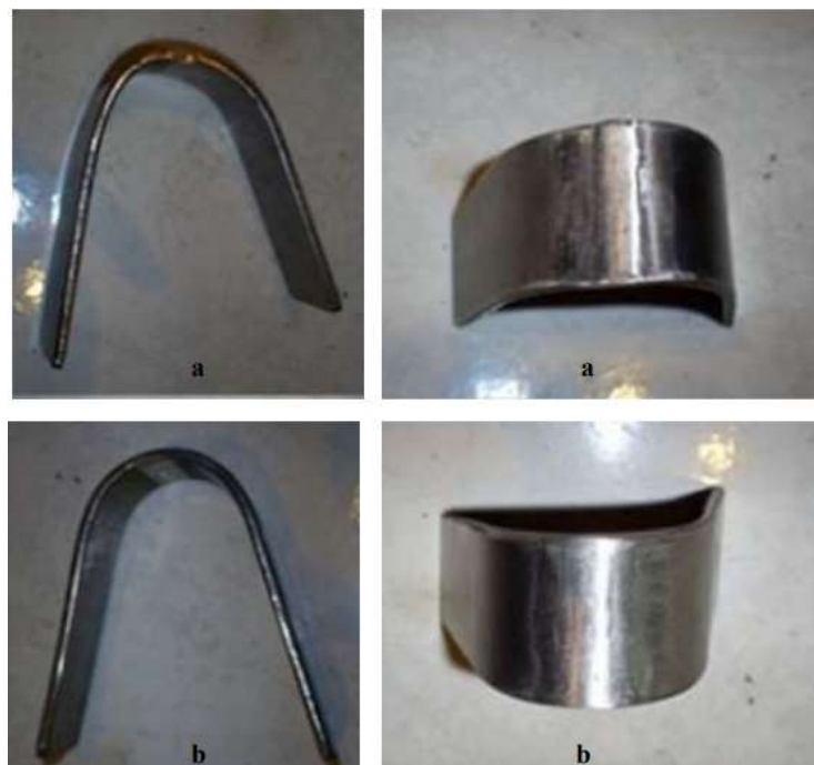
Figura 62: (a) Doblado de cara y (b) doblado de raíz en las juntas soldadas por el proceso SMAW
