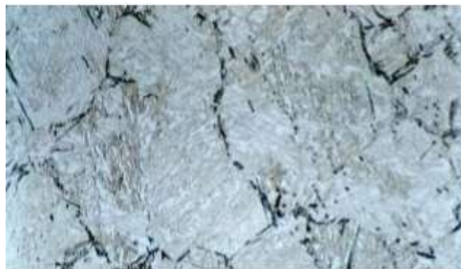
Figura 5: Presencia de bainita
