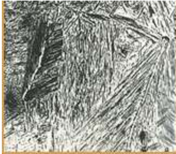
Figura 2: Microestructura de la Martensita.
