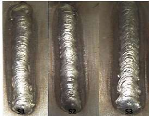
Figura 46: Depósitos de soldadura realizados con las condiciones del proceso SMAW
