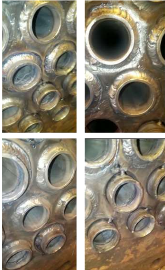
Figura 65: Uniones soldadas por soldadura SMAW entre acero ASTM A36 y acero AISI 304
