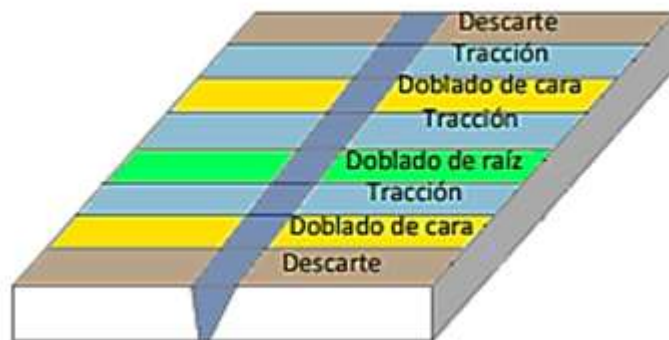
Figura 55: Esquema de corte de los cupones para ensayos destructivos
