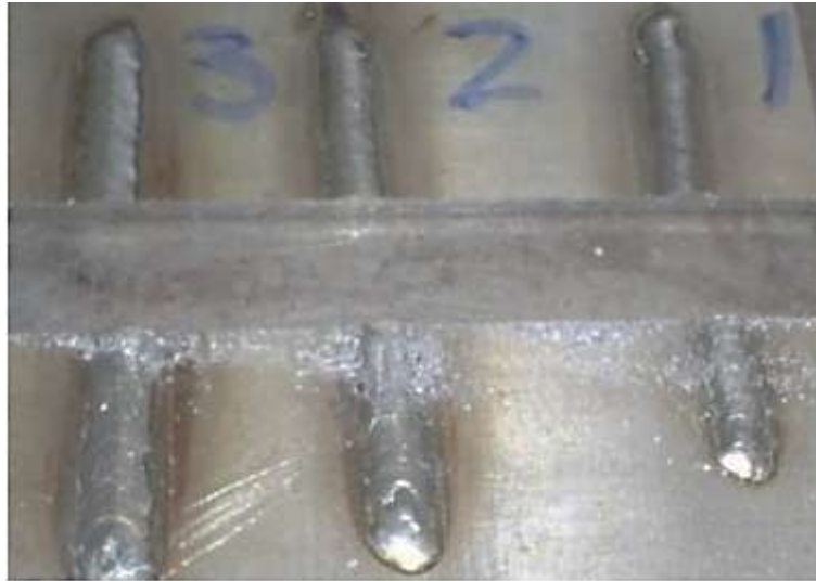
Figura 47: Corte de los cordones de soldadura para inspección SMAW Fuente: González A. - Rojas J. (2021)
