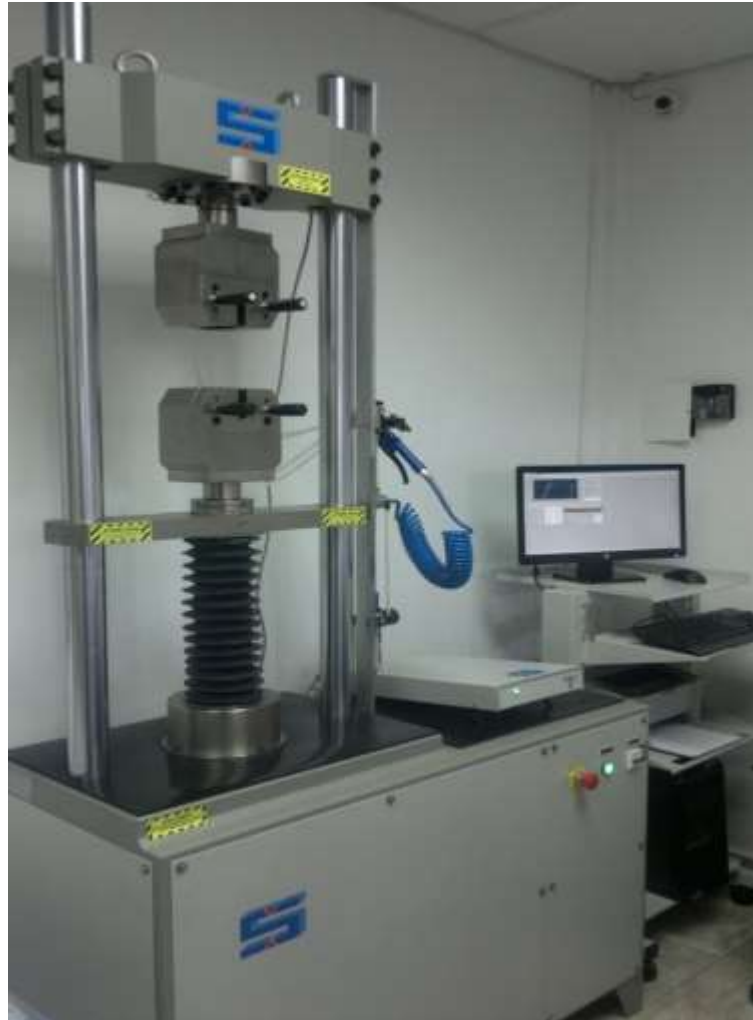
Figura 26: Máquina de ensayo de tracción marca. Sistemas de Ensayos, S.L Modelo MEM-101-10-SDC Fuente: Trexa, C.A. (2017)
