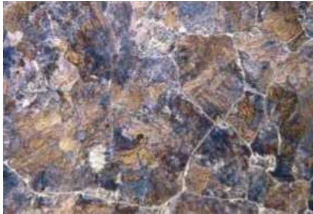
Figura 6: Presencia de Austenita.
