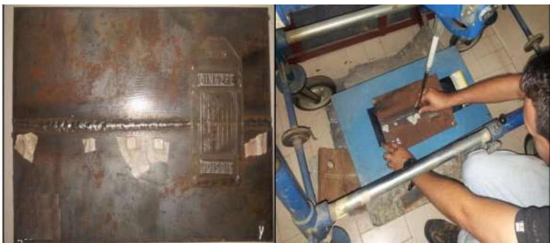
Figura 52: Identificación y montaje de láminas en equipo de rayos X.
