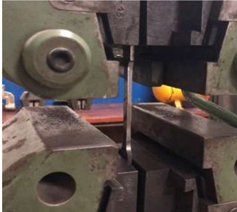
Figura 35: Probeta en la Maquina de Ensayos de Tracción Fuente: González A. - Rojas J. (2021)
