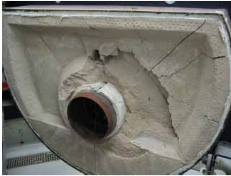
Figura 25 Rotura y desprendimiento de refractario Por puesta en marcha inicial demasiado rápida. Fuente: Mantenimiento de calderas industriales, Boch 2016.
