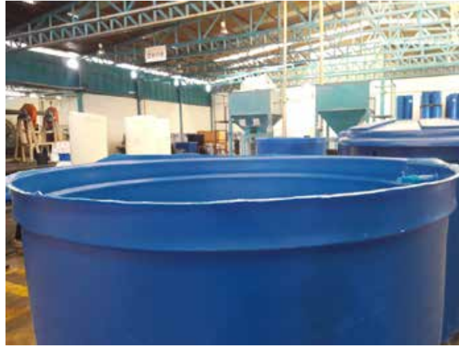
Figura 17: Imperfección del tanque por uso de herramienta de corte.
