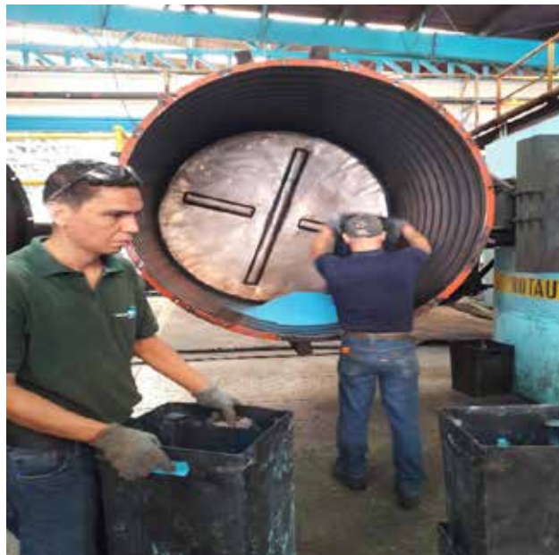
Figura 13: Carga de materia prima en molde tipo cisterna de 3.000L.
