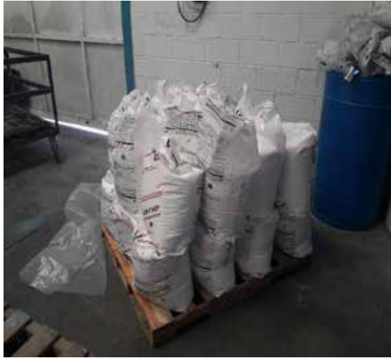
Figura 7: Sacos de 12Kg. con polietileno 84-07 pigmentado para rotomoldeo.
