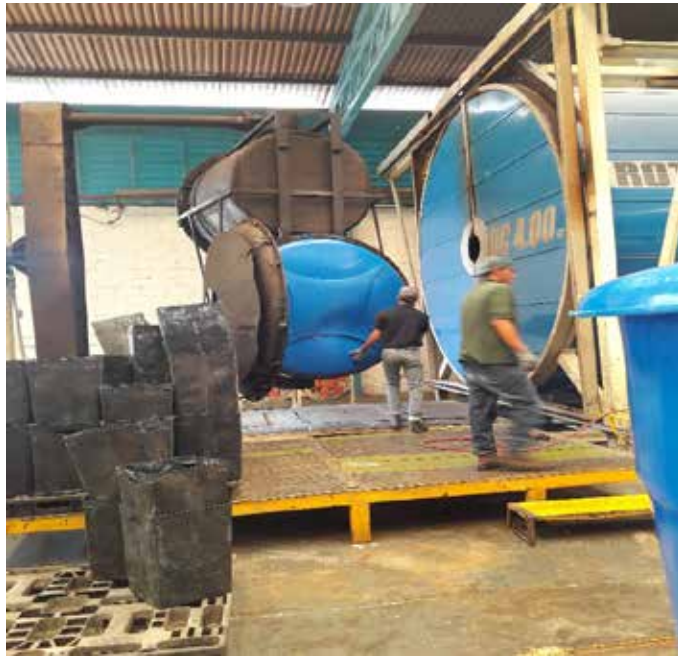
Figura 14: Operador realizando el desmoldeo de tanque cónico de 5.000L.
