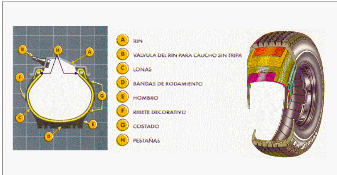
Figura 1 Corte del Neumático y sus Partes
