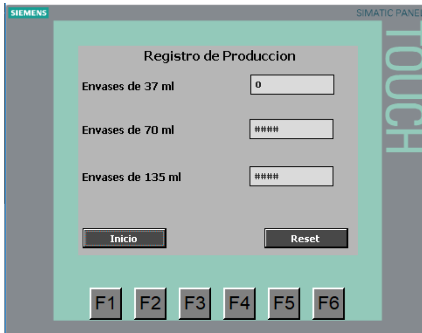
Figura 52. HMI Registro de producción. Fuente: Binetti (2019)
