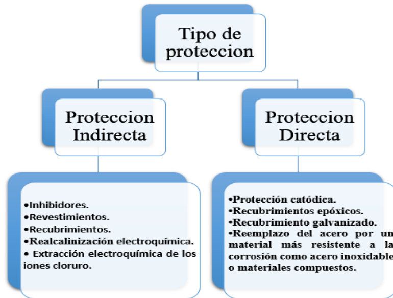
Figura 26. Tipos de protección de la corrosión.
