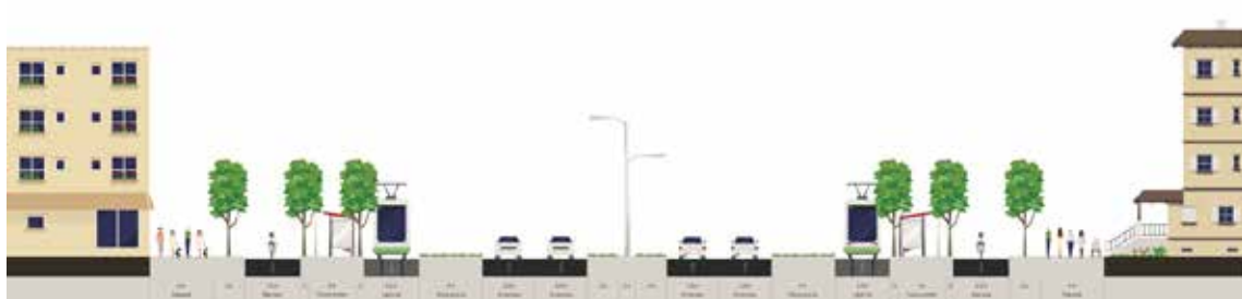
Figura 11. Perfil vial de las avenidas principales. Bakhos y otros
