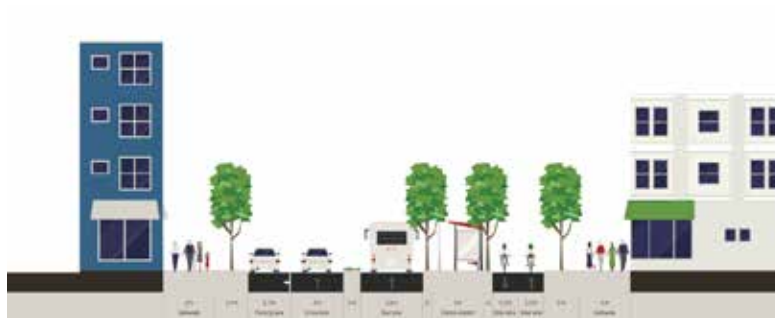
Figura 12. Perfil vial de las avenidas colectoras. Bakhos y otros
