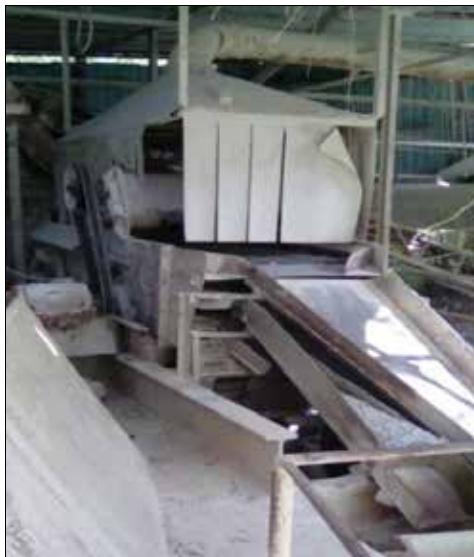
Figura 10. Criba Mogensen y funcionamiento
