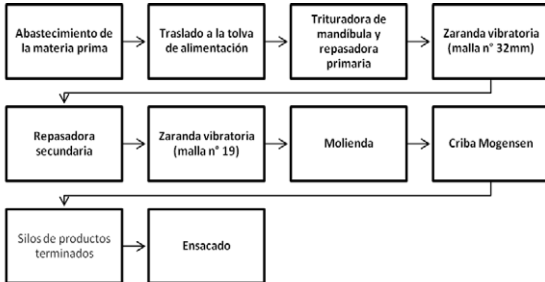
Figura 13. Diagrama de bloque del proceso productivo de la Línea de Criba Fuente: García (2019)
