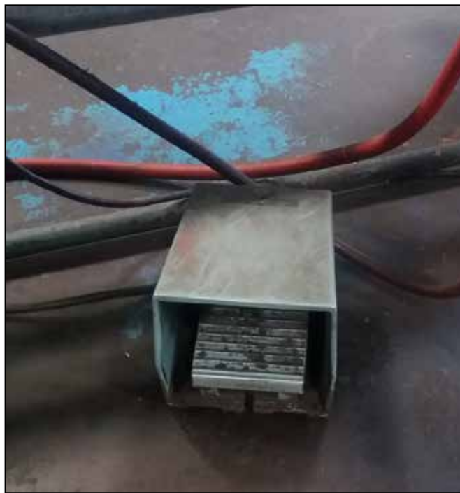
Figura 31: pedal que acciona la cortadora
