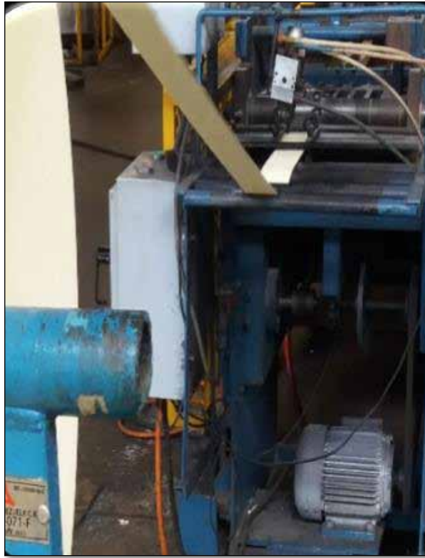
Figura 21: Papel guiado por los rodillos tensores hasta la plisadora
