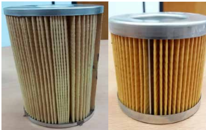
Figura 1. Diferencia entre elementos sellados con resina y clip de acero.
