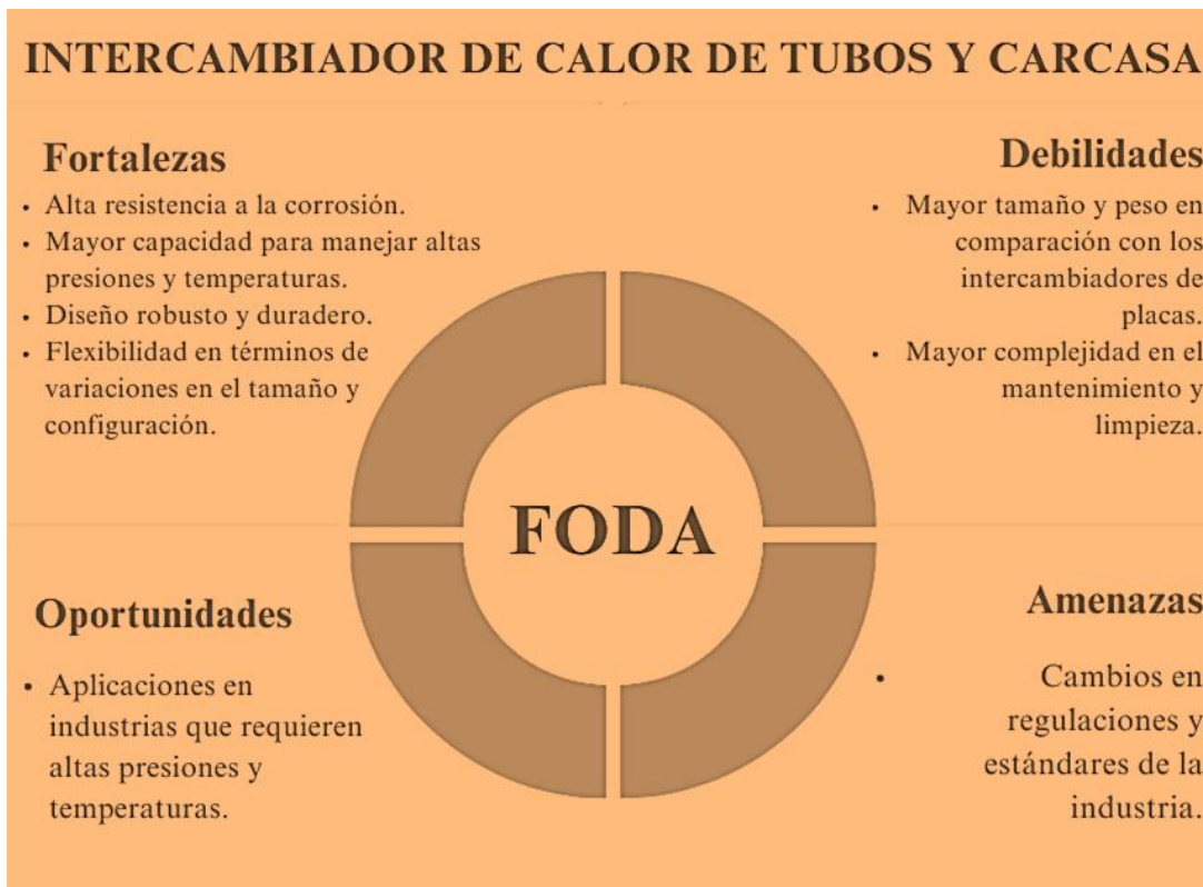
Figura 35: Matriz FODA – Intercambiador de calor de tubos y carcasa. Fuente: Rosales, D.
