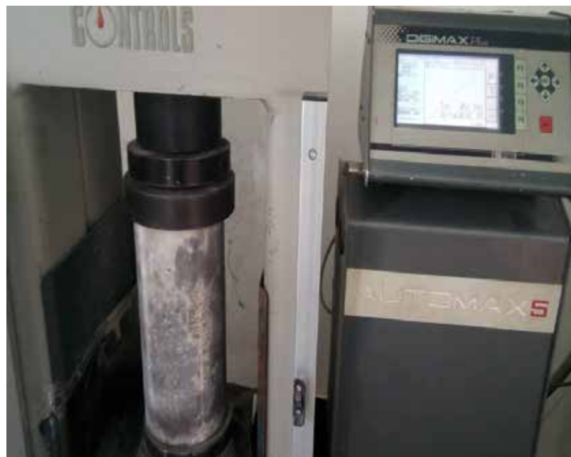
Figura 23. Ruptura de probetas a la Compresion, Laboratorio Empresa Framex Fuente. Los autores (2018)
