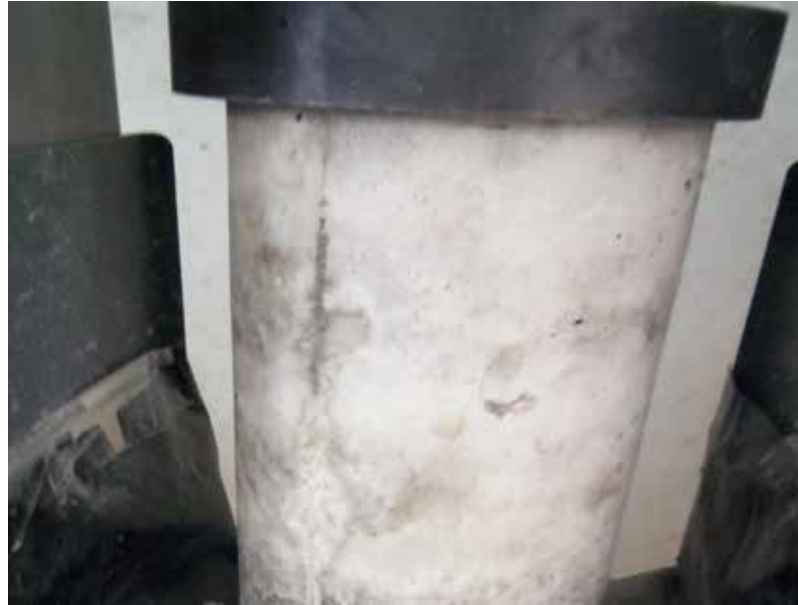
.Ruptura de probetas a la Compresion, Laboratorio Empresa Framex Fuente. Los autores (2018)
