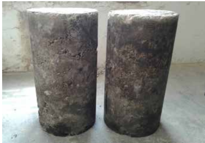
Muestreo 1. Probetas con gran cantidad de vacíos
