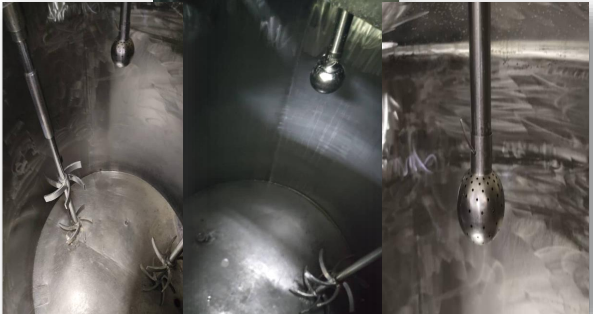
Figura n°25. Ilustración SPRAY BALL (BOLA CON AGUJERO) para aplicación de químicos. Los tanques que son higienizados por el CIP son 5, 4 de premix y 1 de llenado.
