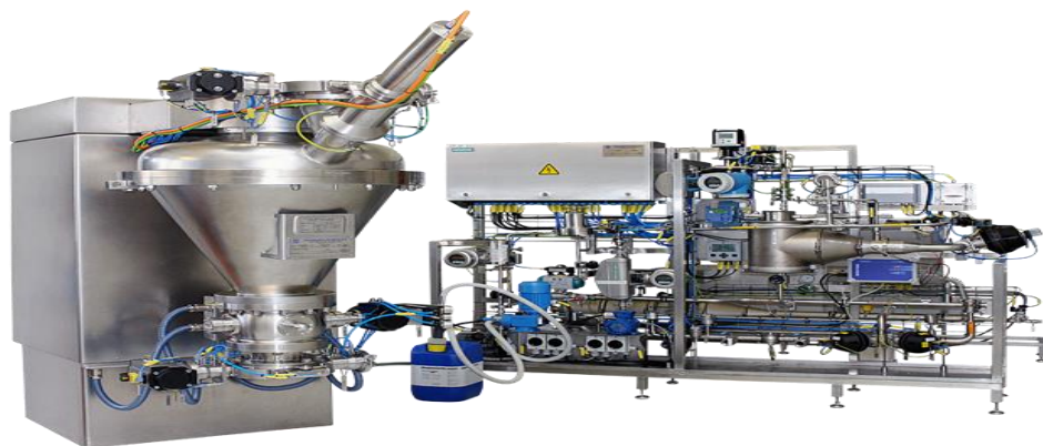
Figura N° 11: Instalación de sistema CIP Fuente: Manual técnico de Limpieza en Sitio –CIP
