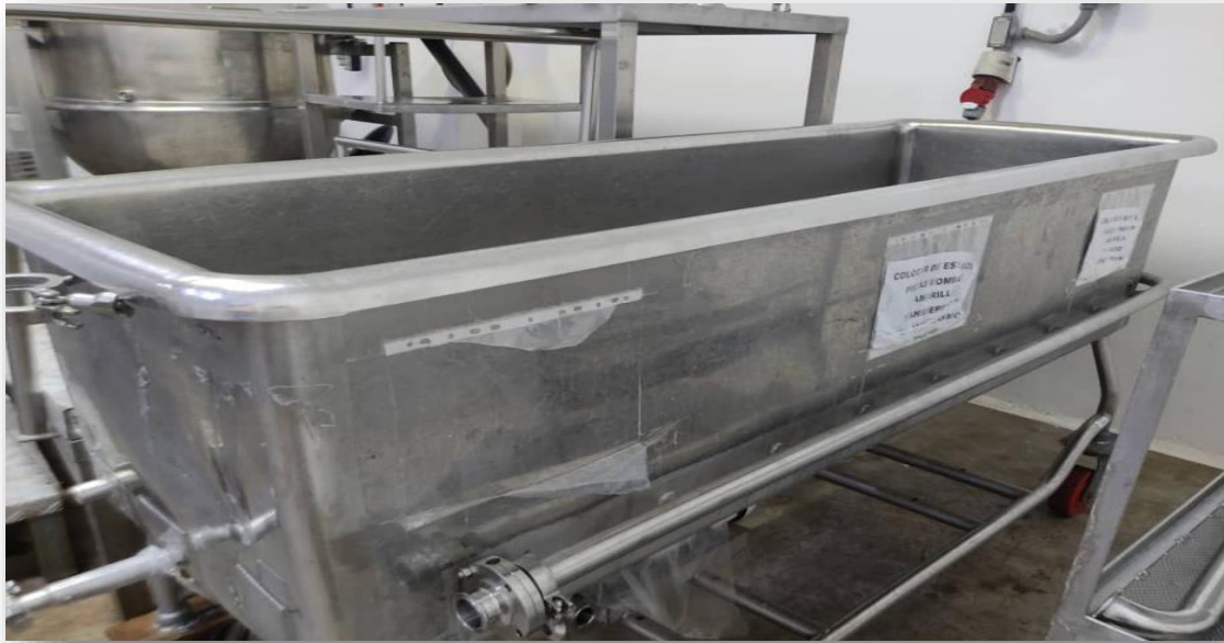
Figura n°26. Ilustración Canoa donde se hace el COP (Limpieza fuera de SITIO) aplica para todas aquellas piezas desmontables.
