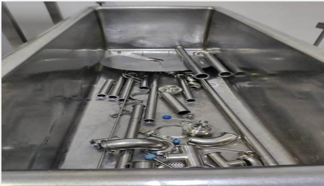
Figura n° 27. Ilustración Canoa donde se hace el COP (Limpieza fuera de SITIO) aplica para todas aquellas piezas desmontables.
