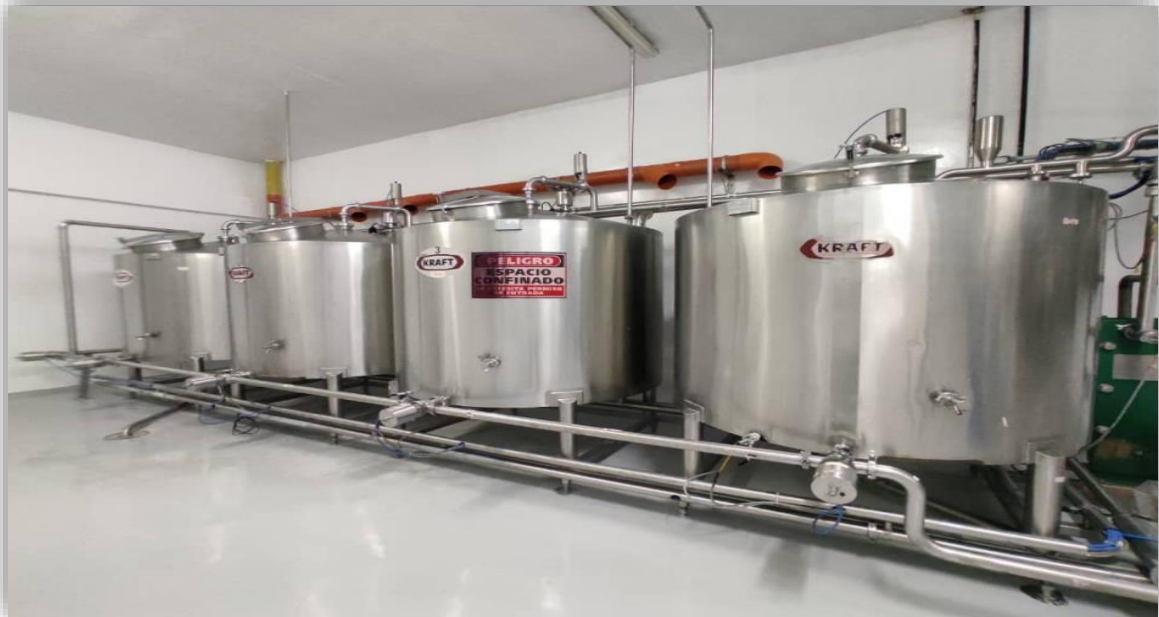
Figura n°18. Ilustración de los tanques para CIP
