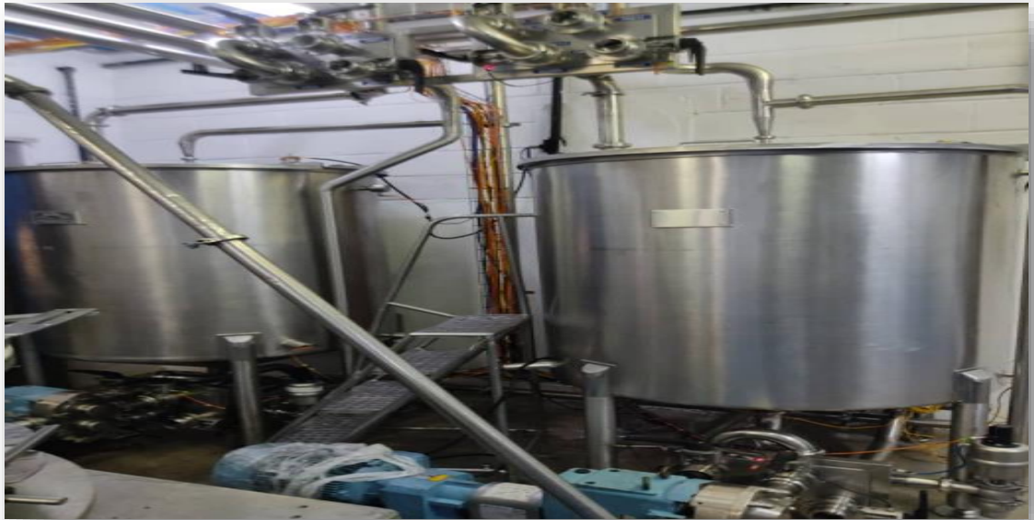
Figura n°24. Ilustración de tanques de llenado
