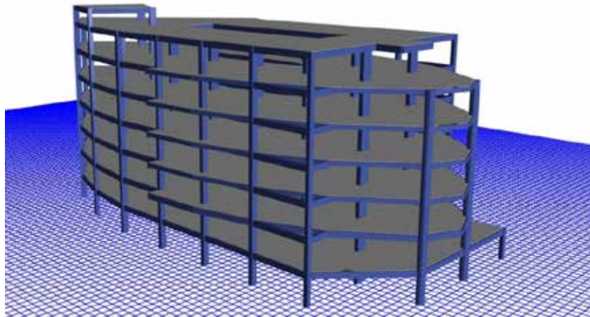
Figura 12 Modelo matemático 3D realizado en software de análisis estructural.
