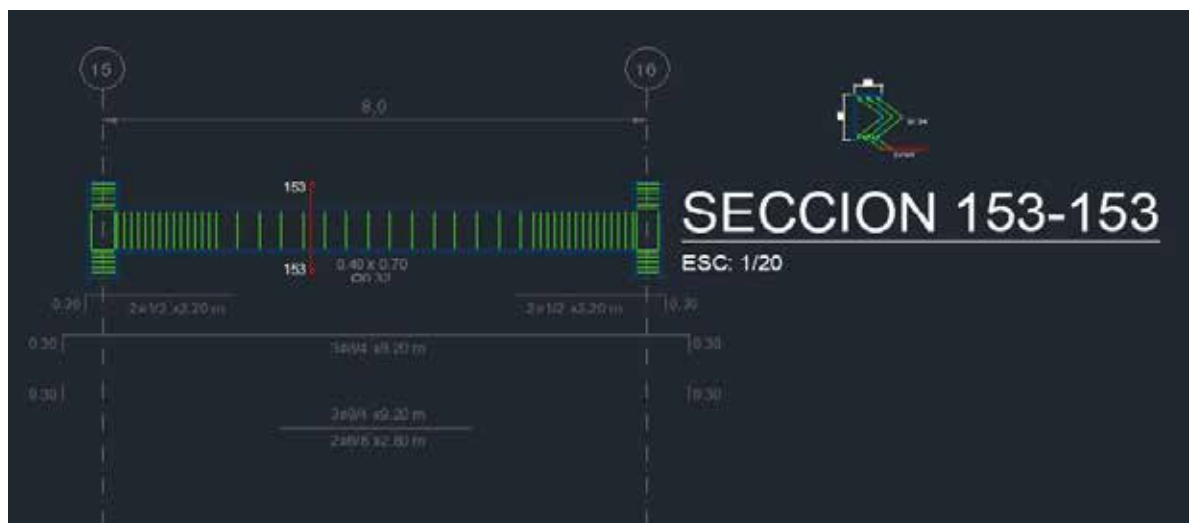
Detalle de separación de estribos en vigas.
