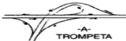
Figura 9: Ejemplo de Intersección a Desnivel A
