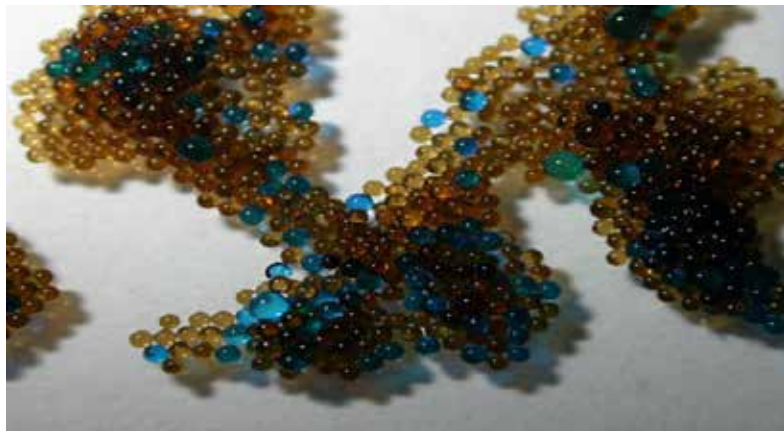
Figura 23. Esferas de gel sintético llamadas también resina de intercambio iónico.
