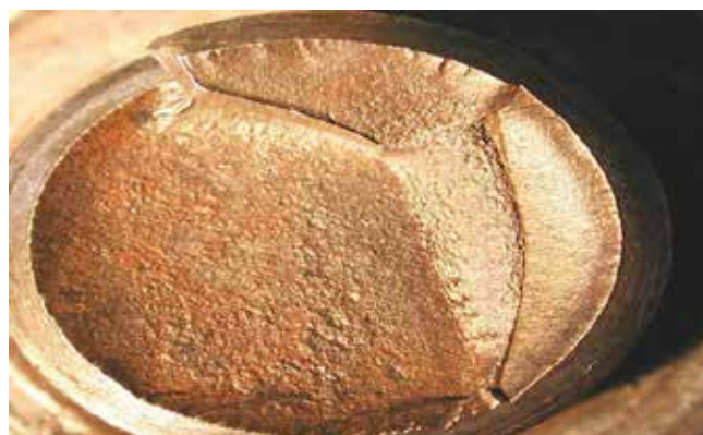
Figura 29. Ejemplo de corrosión con fractura por fatiga.
