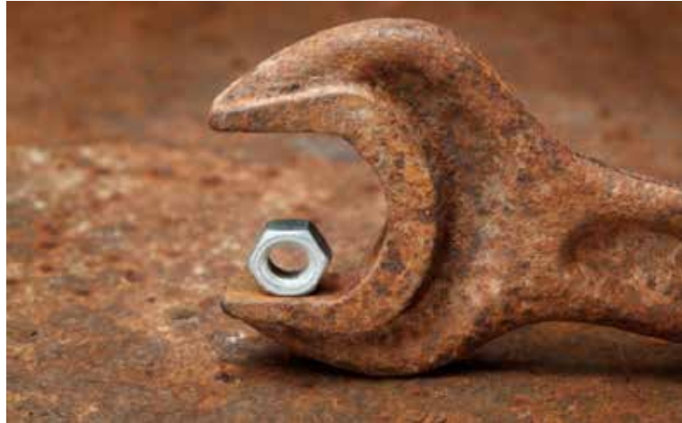
Figura 25. Ejemplo de corrosión generalizada.
