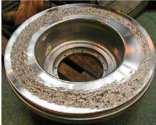
Figura 32. Ejemplo de corrosión – erosión.
