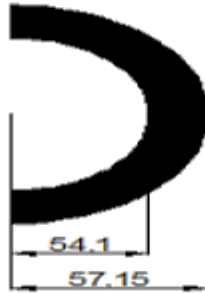
Figura 39: Elemento uno del brazo de recolección. (Dimensiones en mm) Fuente: Propia (2.020)
