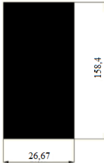
Figura 41: Elemento tres del brazo de recolección. (Dimensiones en mm) Fuente: Propia (2.020)
