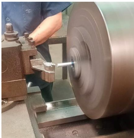
Figura 26: Desbaste de material en la fabricación de aguja
