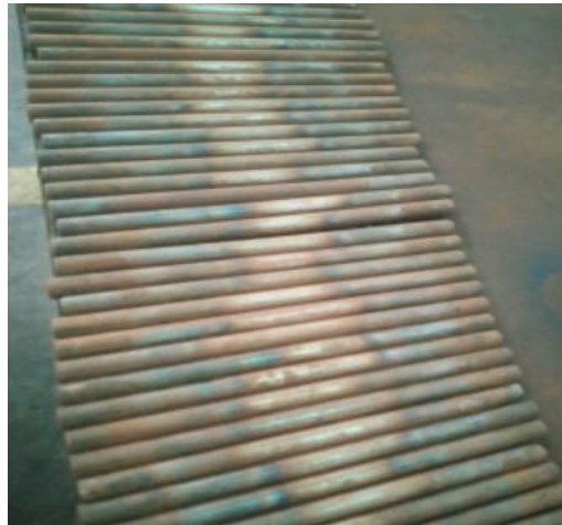
Figura 18: Varillas expulsadoras con templado y revenido
