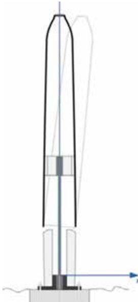
Figura 17: Dispositivo de recolección de energía eléctrica vortex (2019)
